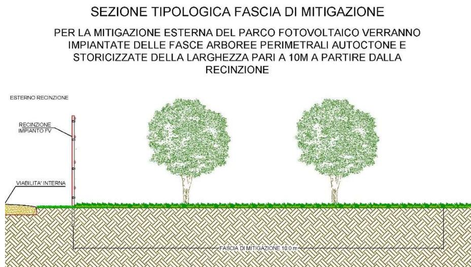
*Fig. 30 - Sezione tipologica fascia di mitigazione*
