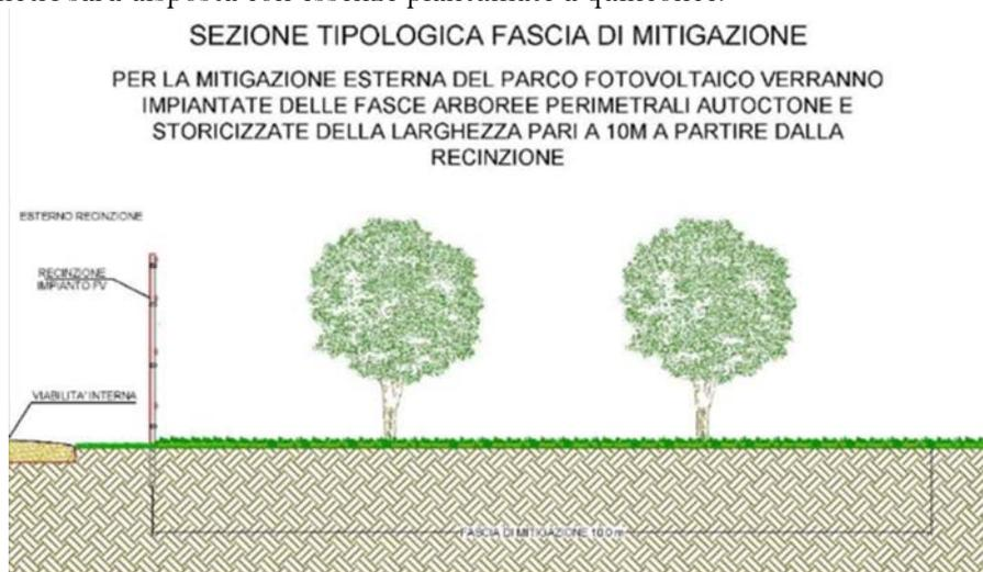
Figura 26 - Schema delle opere di mitigazione visuale previste per tutti i confini dell'area di impianto. FVRCMD-I\_PD SIA08 - Analisi di intervisibilità territoriale - valutazione opere di mitigazione visuale
