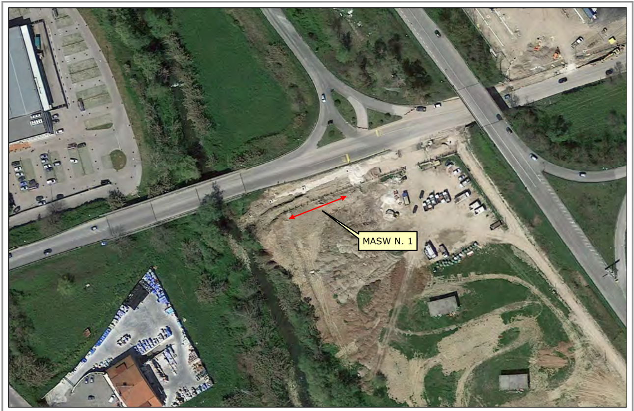
Via S. Pertini - Ubicazione su ortofoto dell'area di intervento e dell'indagine sismica MASW
