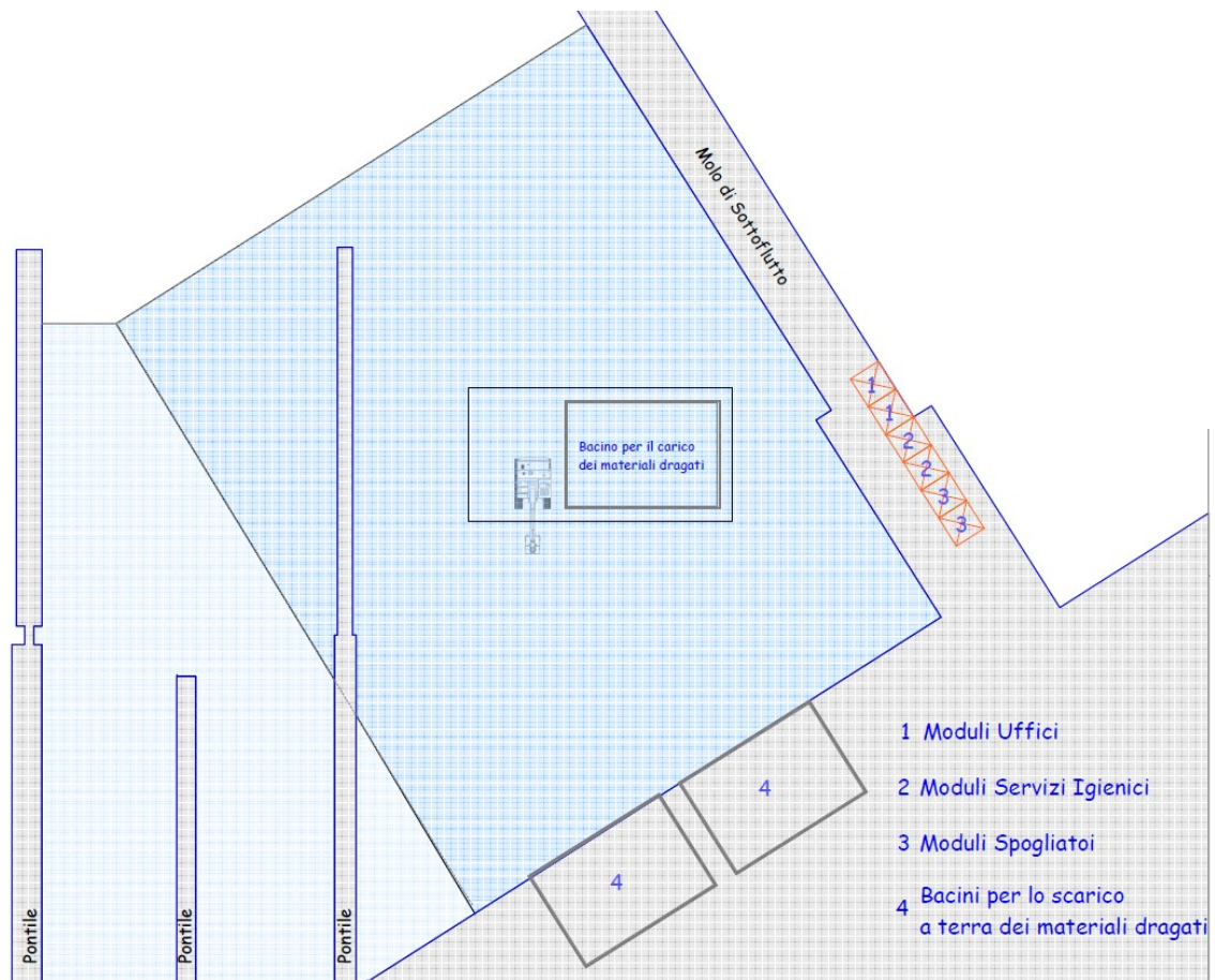
Figura 10. Organizzazione del cantiere (Fonte: elaborazione propria).
