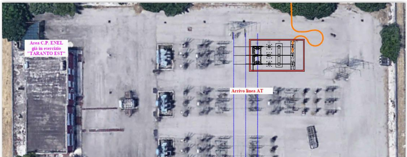
Fig. 32. Posizionamento dello stallo di connessione alla RTN riquadrato in rosso
