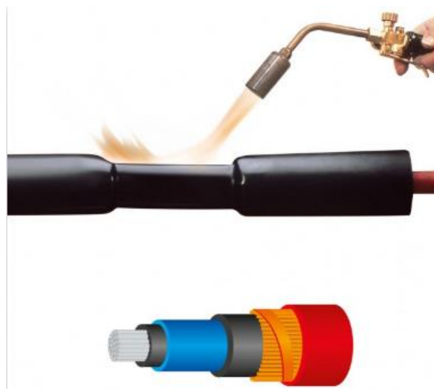
Fig. 23. Schema di esecuzione di un giunto MT.
