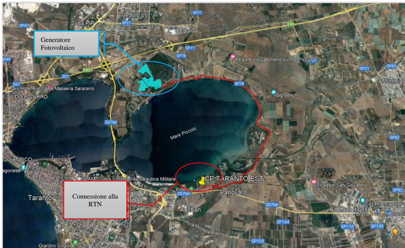
Fig. 1. Inquadramento di ampio raggio su ortofoto dell'area di intervento, a Nord, in celeste, la centrale fotovoltaica; in rosso, il percorso dell'elettrodotto dorsale, che si sviluppa per circa 23,5 km prevalentemente lungo rete viaria esistente; a SUD la Sottostazione Produttore, nei pressi della futura Stazione elettrica di Trasformazione SET-TERNA 380/150kV.
