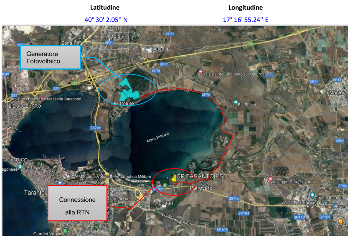
Fig. 1. Inquadramento di ampio raggio su ortofoto dell’area di intervento, a Nord, in celeste, la centrale fotovoltaica; in rosso, il percorso dell’elettrodotto dorsale; a SUD la Sottostazione Produttore e il sistema di accumulo da 25/50 MW nei pressi della cabina primaria “TARANTO EST”
