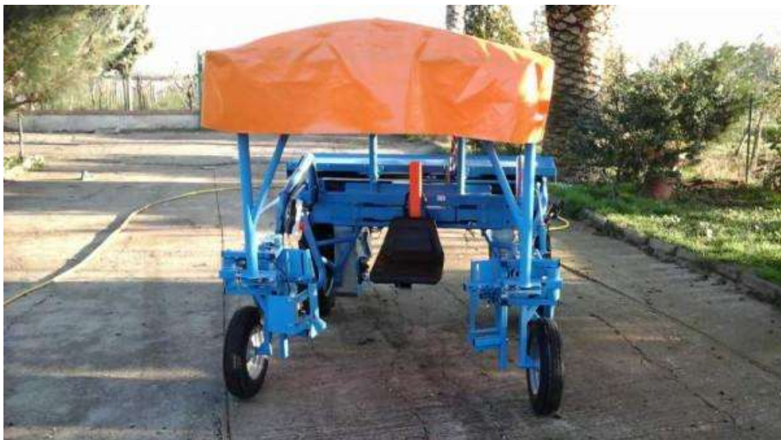
63 - esempio di macchina agevolatrice nella raccolta del carciofo: maggiore efficienza e riduzione dei costi di raccolta del 30%
