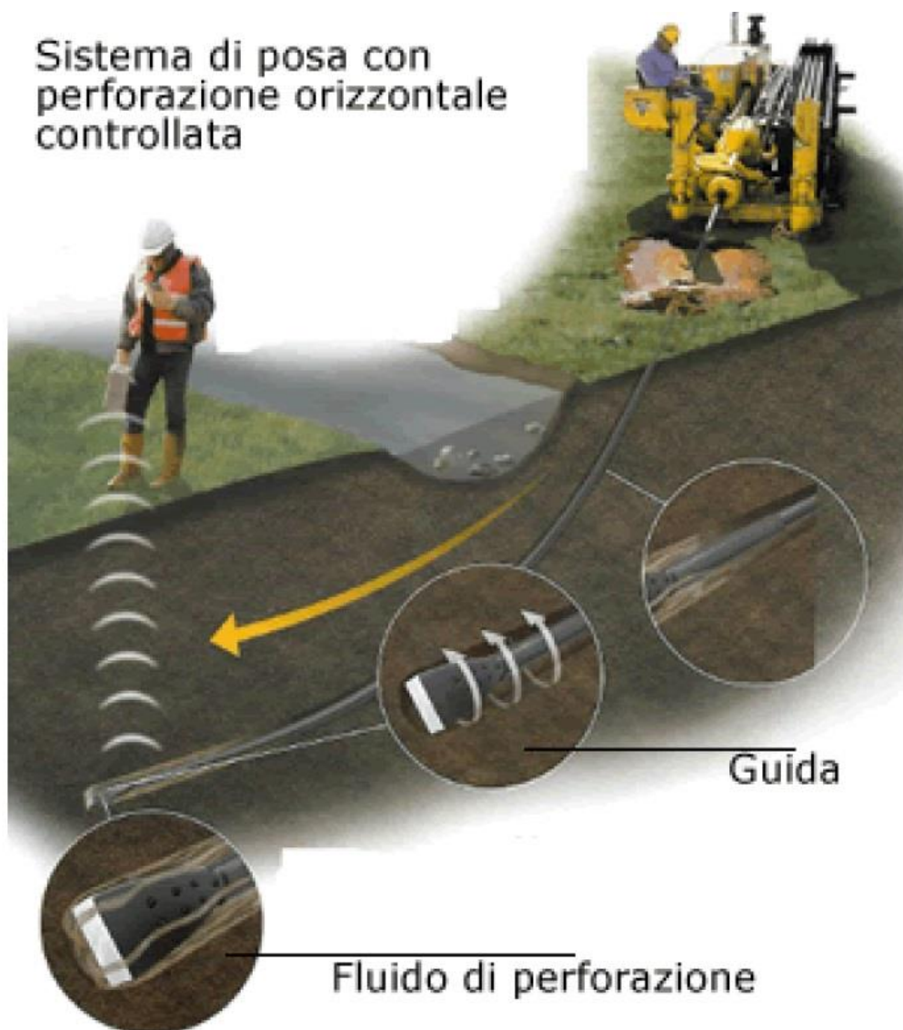
Sistema di trivellazione orizzontale controllata (T.O.C.).
