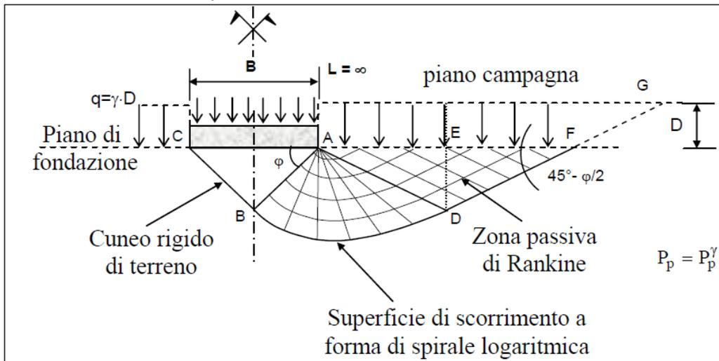
Il terreno è schematizzato come un mezzo continuo, omogeneo e isotropo, a comportamento rigido plastico e per il quale vale il criterio di rottura di Mohr-Coulomb.
