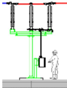
Figura 10\_Tipico sezionatore tripolare – vista prospettica e planimetrica
