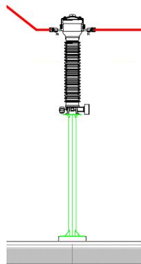
Figura 13\_Tipico trasformatore di corrente – vista prospettica e planimetrica
