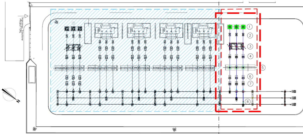
Figura 3\_layout stazione elettrica Terna – stallo condiviso
