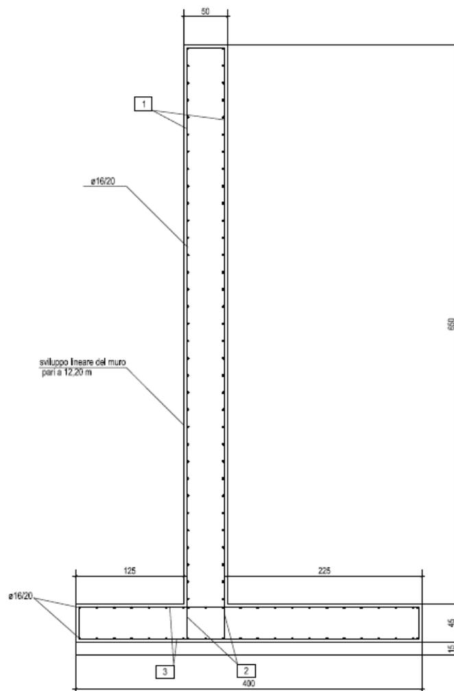
Figura 12\_ sezione muro parafiamma
