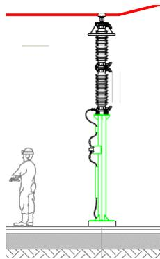
Figura 14\_Tipico scaricatore di sovratensione – vista prospettica e planimetrica
