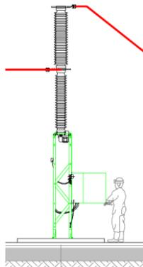
Figura 11\_Tipico interruttore tripolare – vista prospettica e planimetrica
