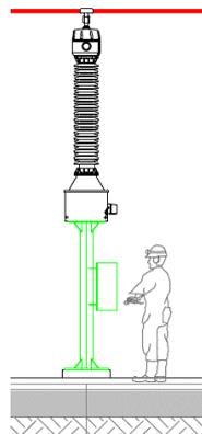
*Figura 12\_Tipico Trasformatore di tensione – vista prospettica e planimetrica*
