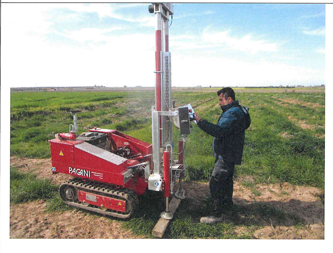
Esecuzione prova DPSH 3
