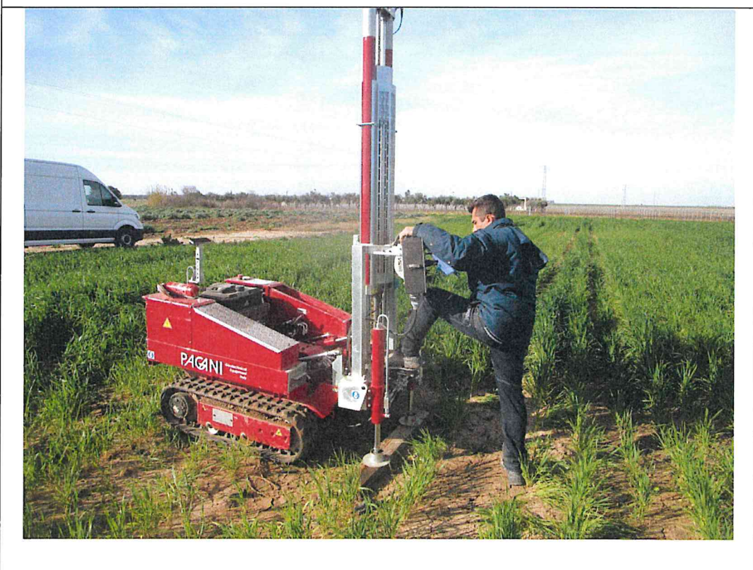
Esecuzione prova DPSH 5
