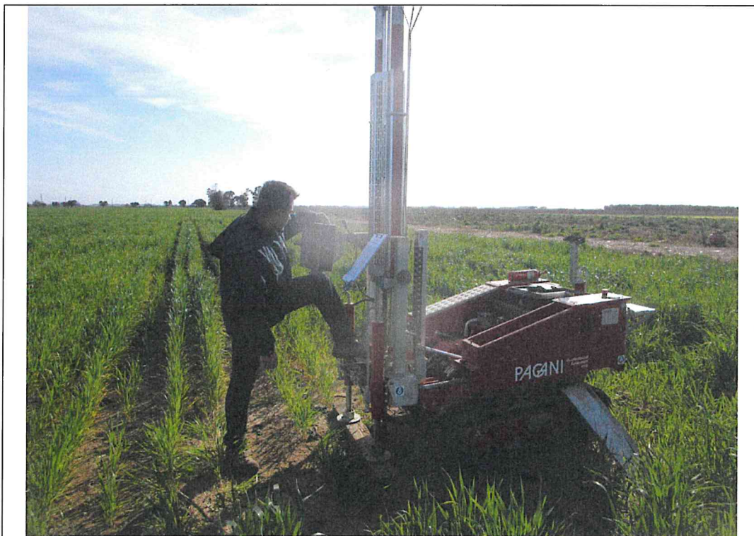
Esecuzione prova DPSH 5
