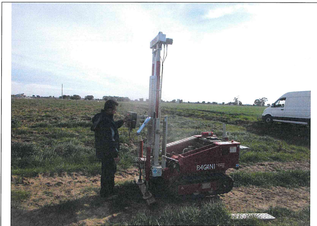
Esecuzione prova DPSH 3
