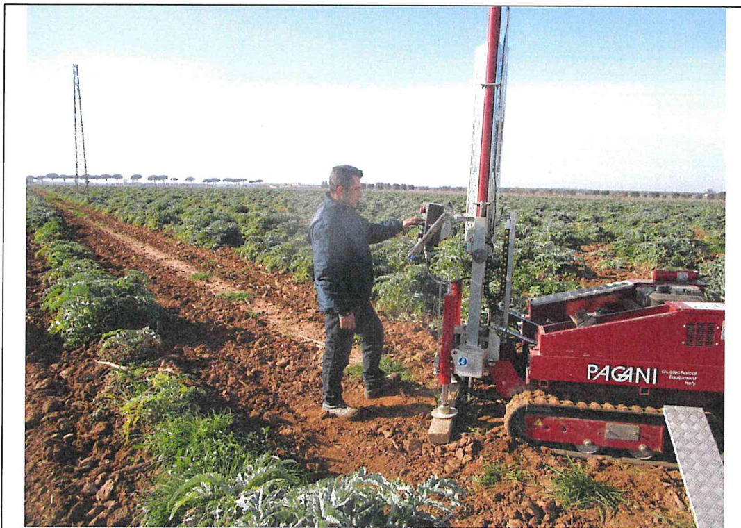
Esecuzione prova DPSH 2
