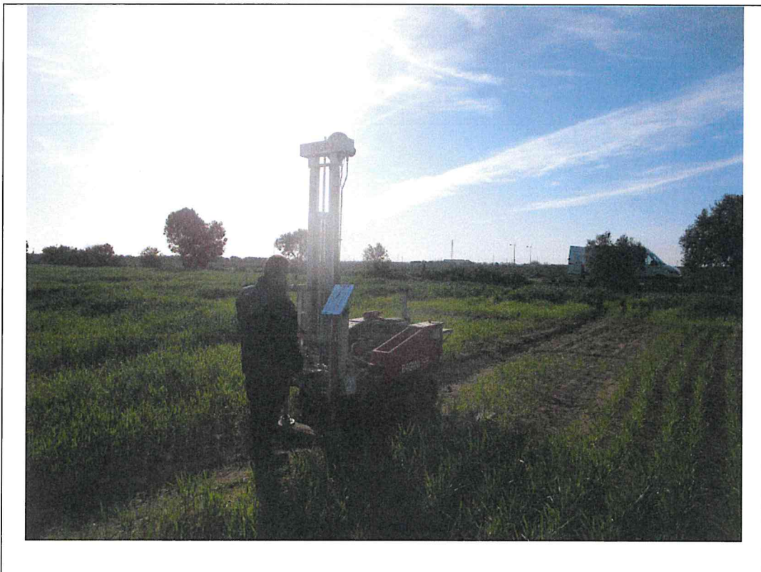
Esecuzione prova DPSH 1
