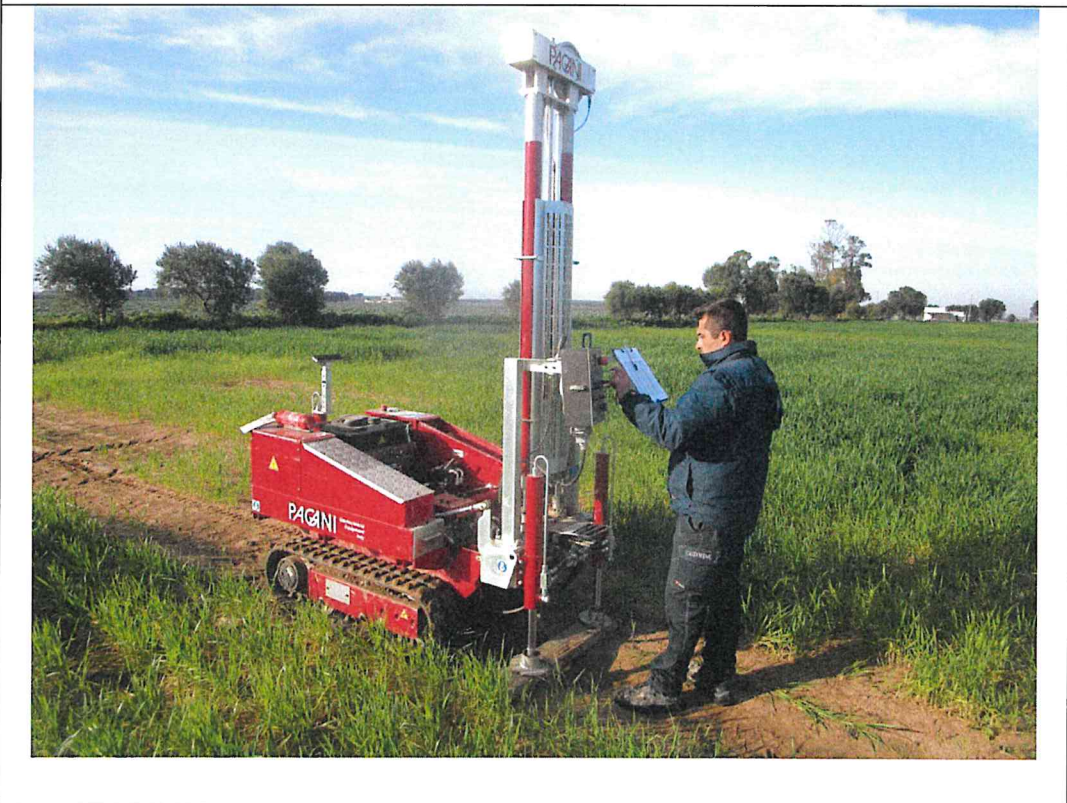
Esecuzione prova DPSH 1
