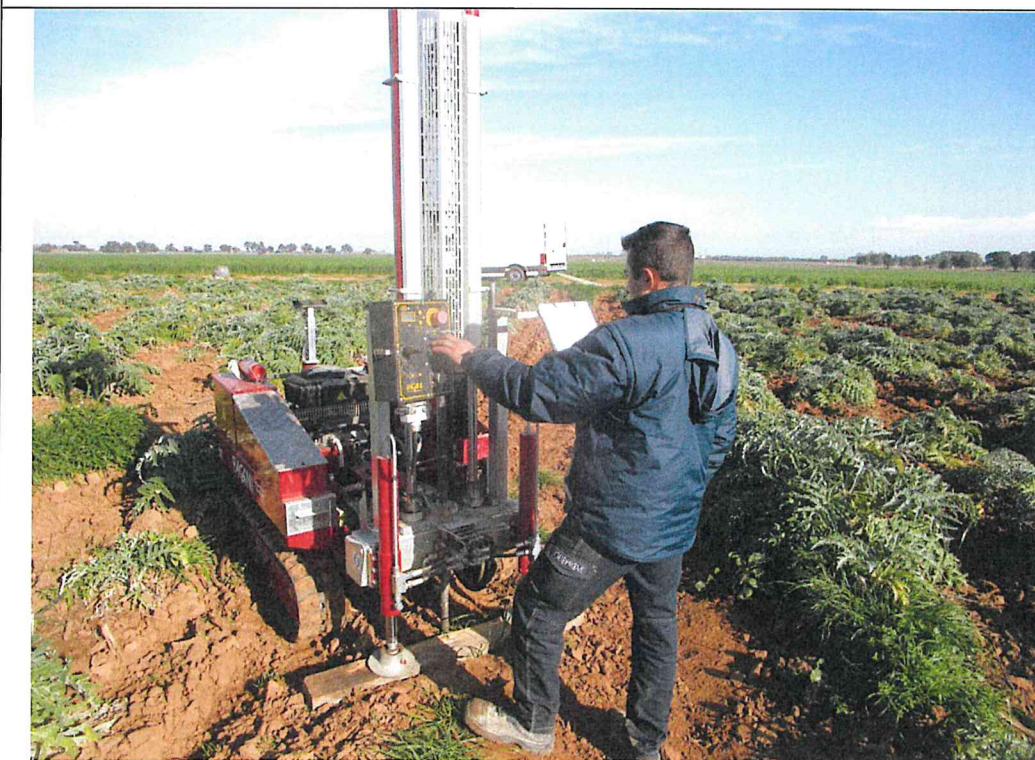
Esecuzione prova DPSH 2
