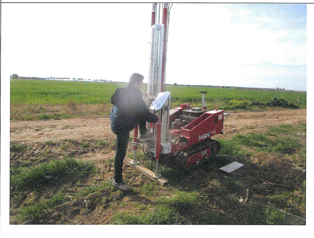
Esecuzione prova DPSH 4
