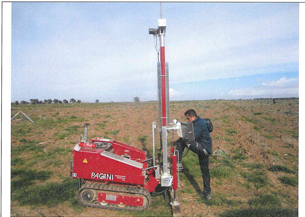
Esecuzione prova DPSH 4
