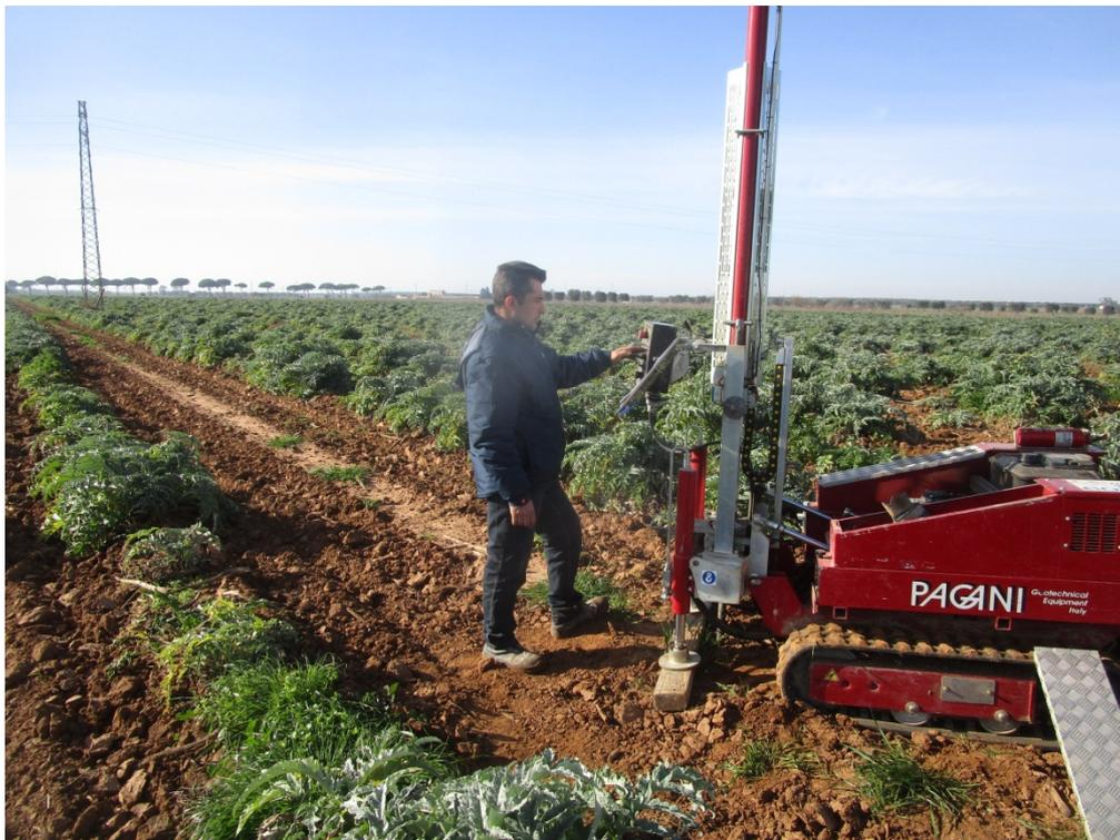
Figura 23: Penetrometro statico/dinamico TG 63-200KN – Pagani: fasi di esecuzione delle indagini (DPSH2).
