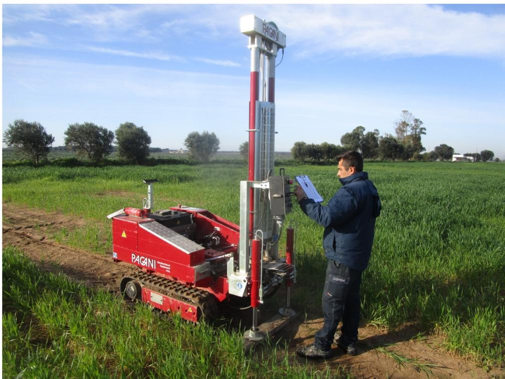
Figura 22: Penetrometro statico/dinamico TG 63-200KN – Pagani: fasi di esecuzione delle indagini (DPSH 1).
