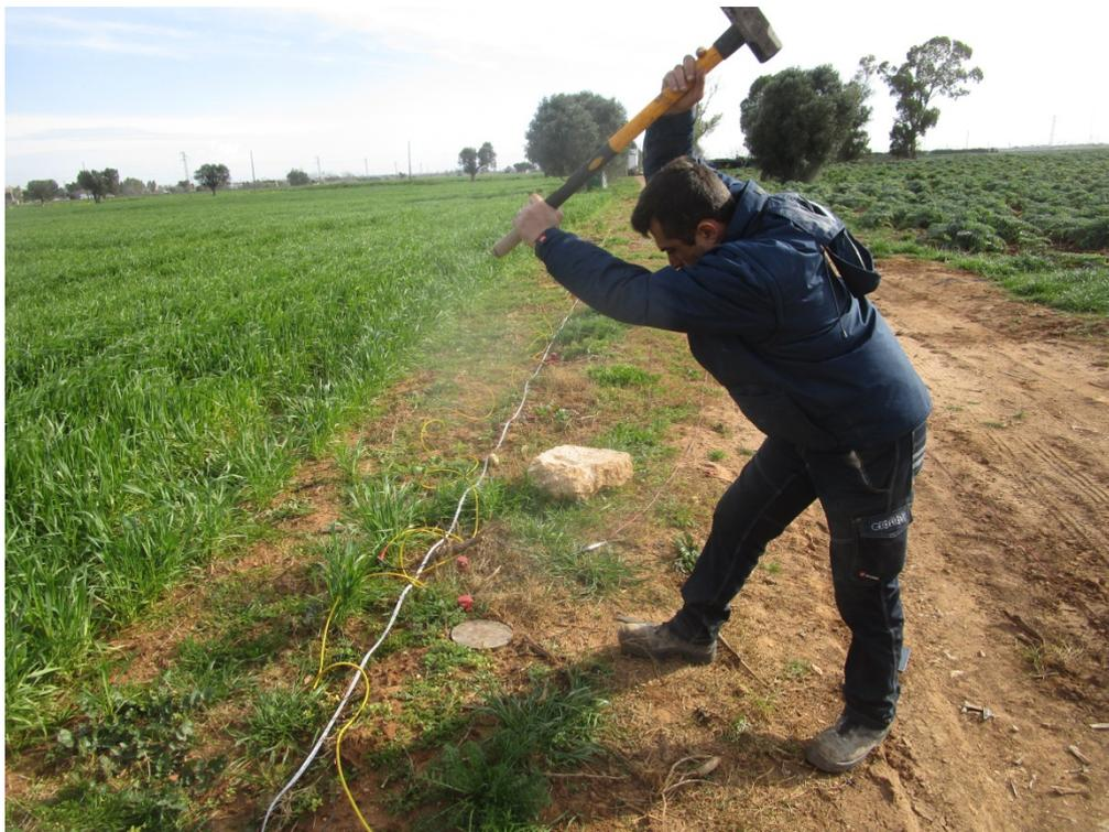
Figura 29: Fase di esecuzione stendimento sismico a rifrazione.
