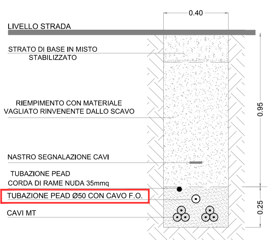
TIPICO CAVIDOTTO STRADE NON ASFALTATE N.2 TERNE
