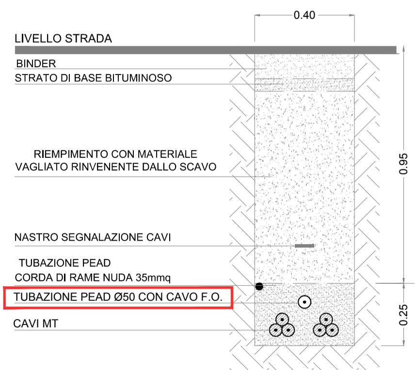
TIPICO CAVIDOTTO SU STRADE ASFALTATE N.2 TERNE
