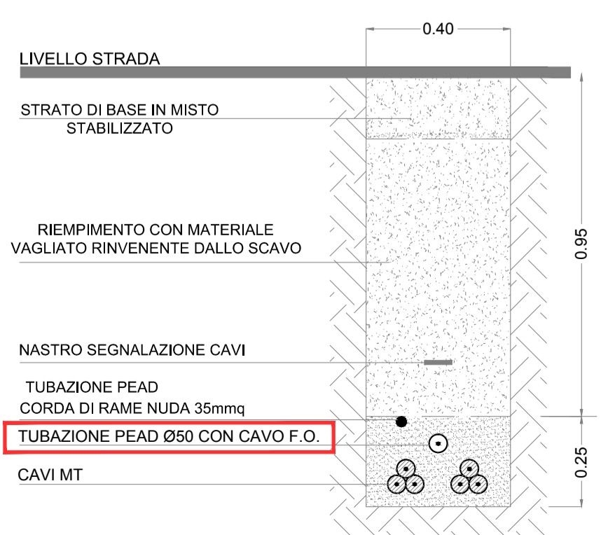
TIPICO CAVIDOTTO STRADE NON ASFALTATE N.2 TERNE
