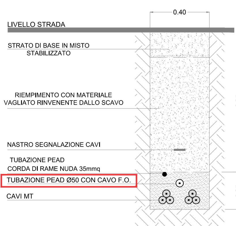
TIPICO CAVIDOTTO STRADE NON ASFALTATE N.2 TERNE
