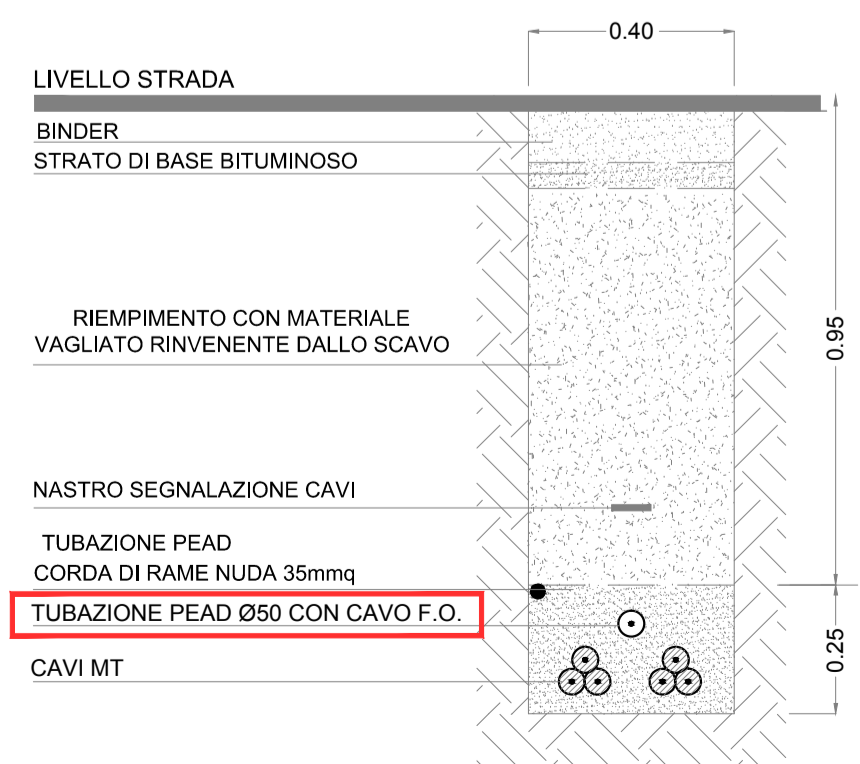
TIPICO CAVIDOTTO SU STRADE ASFALTATE N.2 TERNE
