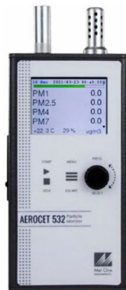
Fig. 8 - Strumentazione per la misura del particolato in continuo
