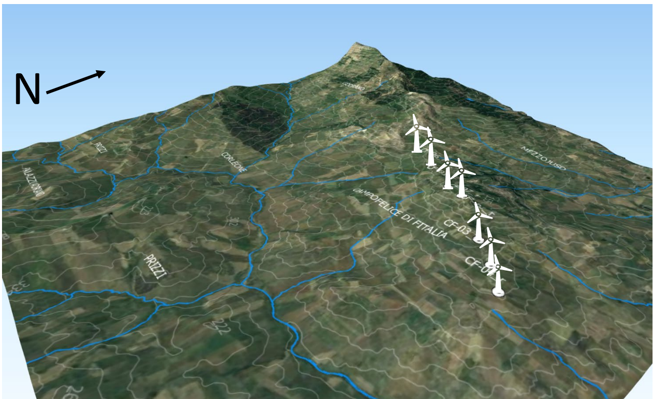
Figura 5-1: Rilievo topografico del Comune di Campofelice di Fitalia corredato di toponimi, curve di livello, corpi idrici superficiali e ubicazione degli aereogeneratori.
