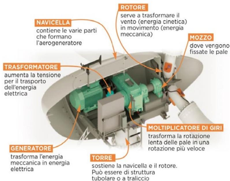
**Figura 3-2: Caratteristiche dettagliate dei componenti presenti in una turbina eolica**
