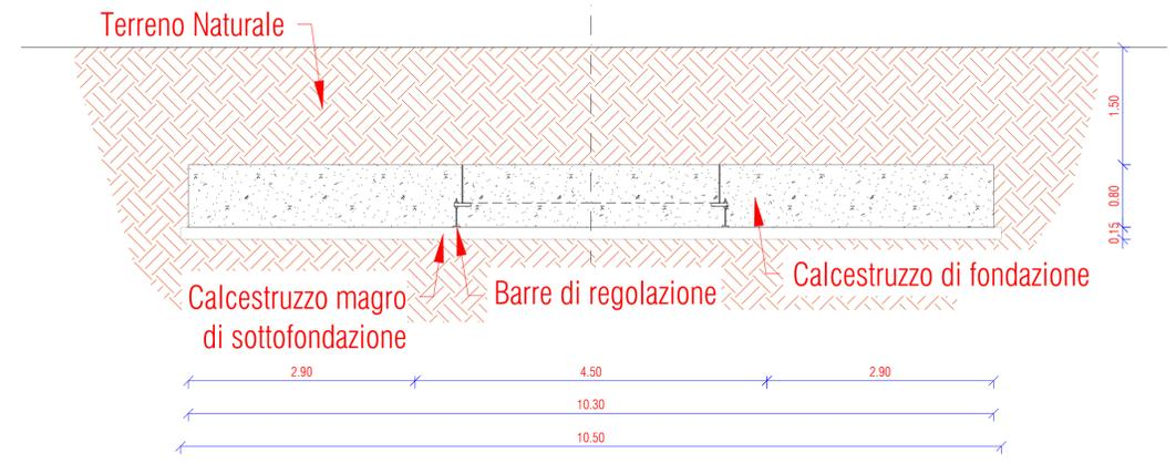
DISMISSIONE AEROGENERATORE - VISTA IN PIANTA
