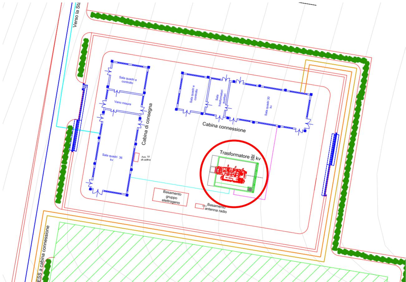
Figura 1. Posizionamento del trasformatore nella SSEU
