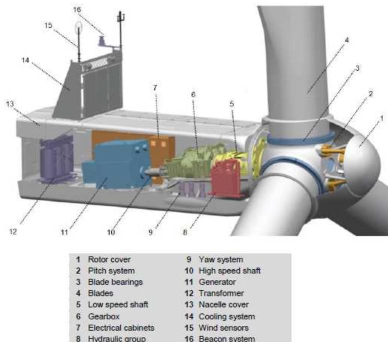
Figura 2. SG 6.6-170. Disposizione dei componenti in navicella
