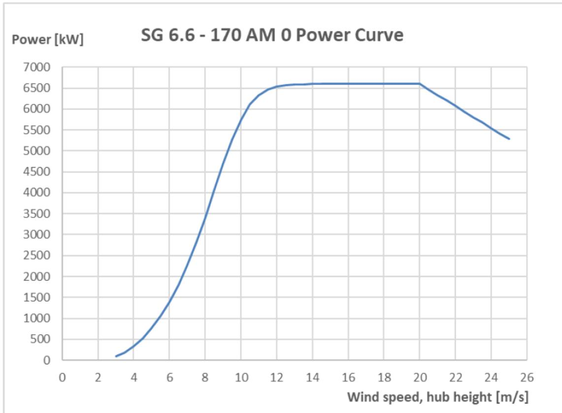
Figura 1. Curva di Potenza di una SG 6.6-170
