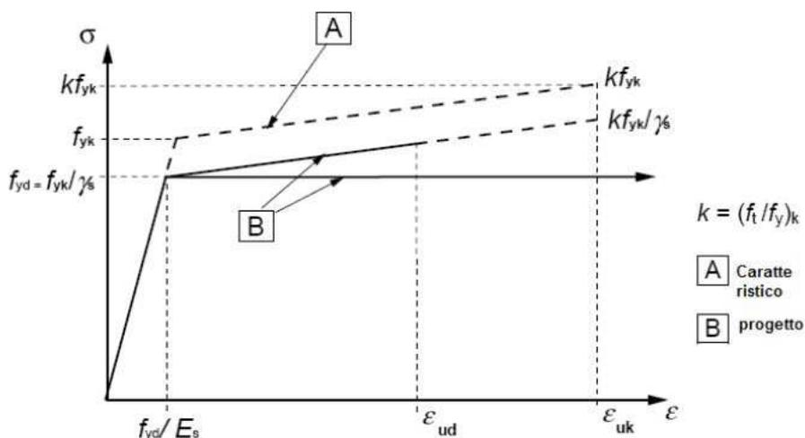
Figura 5: Legame costitutivo di progetto dell'acciaio per c.a.
