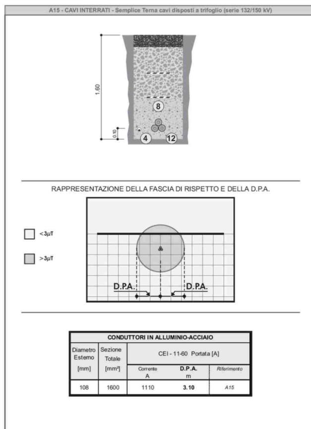
Fig. 5 - Fascia di rispetto cavi interrati 150kV. Fonte: ENEL
