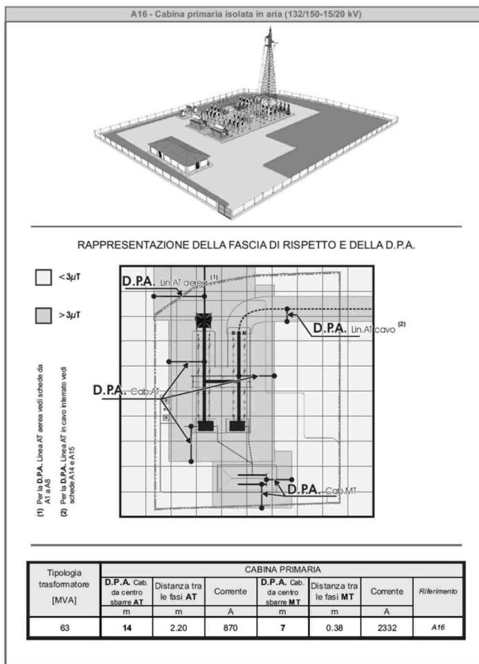
Fig. 6 - Fascia di rispetto cabina primaria 150kV. Fonte: ENEL
