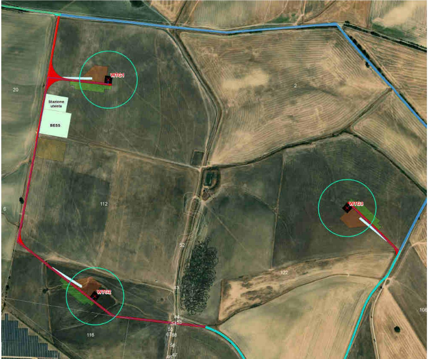
Progetto per la realizzazione di un impianto eolico composto da 5 aerogeneratori da 6,6 MW ciascuno per una potenza complessiva di 33 MW e di un sistema di accumulo elettrochimico da 18 MW sito nel Comune di Montalto di Castro (VT) e opere connesse nei Comuni di Montalto di Castro (VT) e Manciano (GR).
