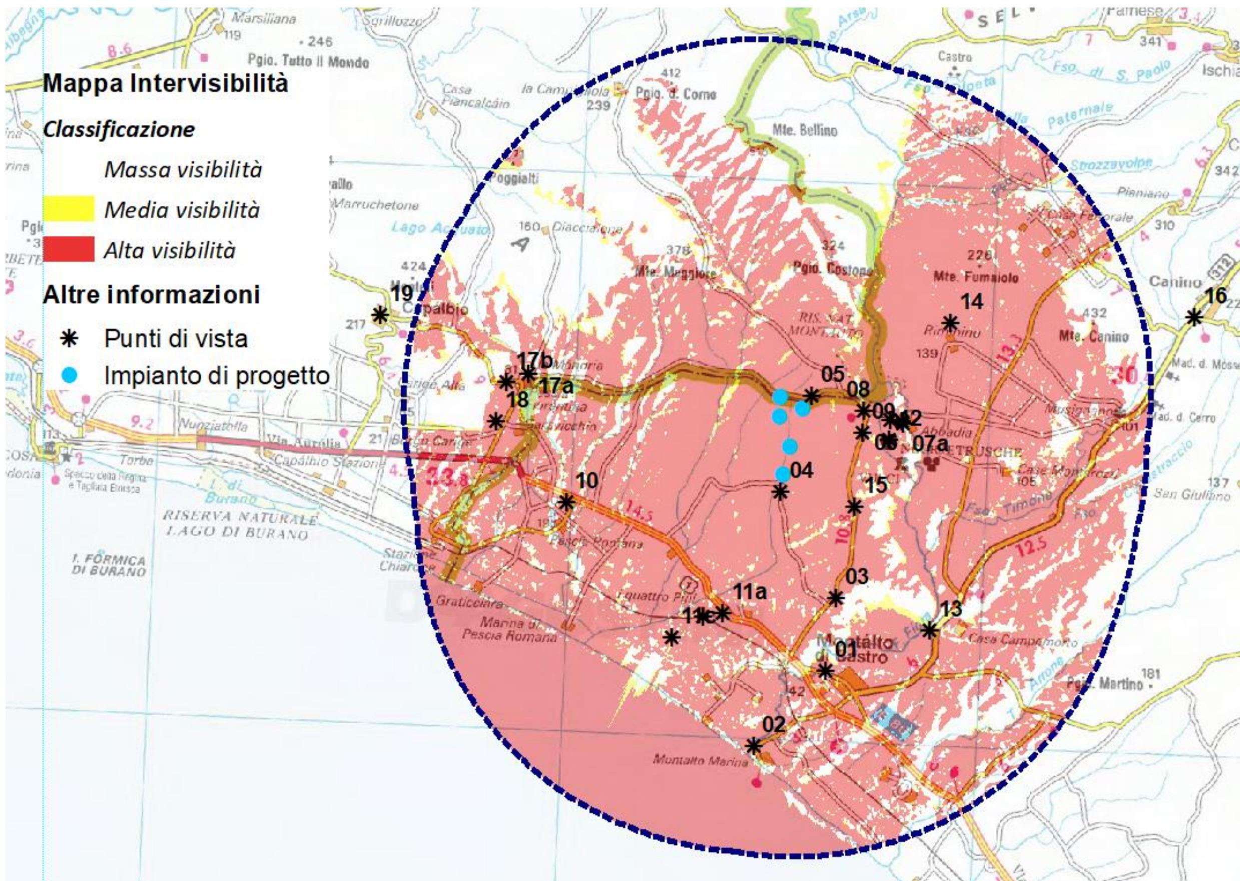
Progetto per la realizzazione di un impianto eolico composto da 5 aerogeneratori da 6,6 MW ciascuno per una potenza complessiva di 33 MW e di un sistema di accumulo elettrochimico da 18 MW sito nel Comune di Montalto di Castro (VT) e opere connesse nei Comuni di Montalto di Castro (VT) e Manciano (GR).
