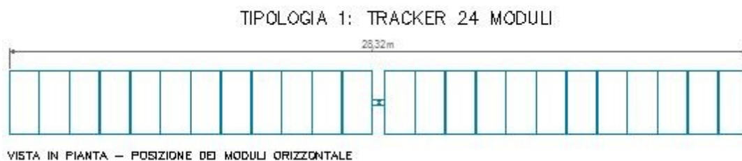
Immagine 7: Esempio di tracker in posizione orizzontale (alle ore 12.00)
