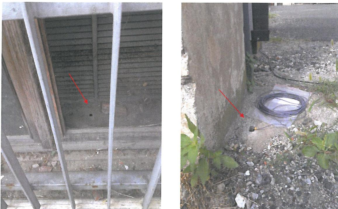
*Figura 4 – Accelerometri monoassiali posizionati su un davanzale del piano seminterrato e in corrispondenza del passo carraio della casa di riposo.*
