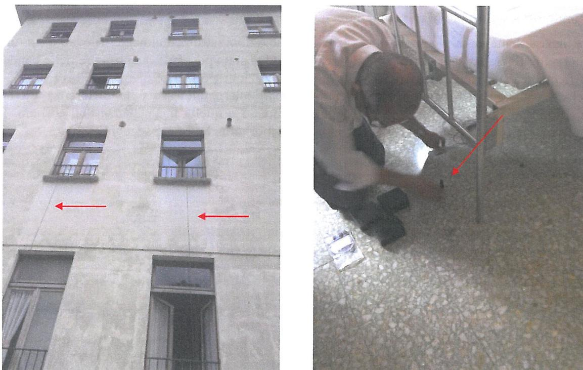
*Figura 5 – Cavi di trasmissione dati degli accelerometri monoassiali posizionati nelle stanze di degenza.*
