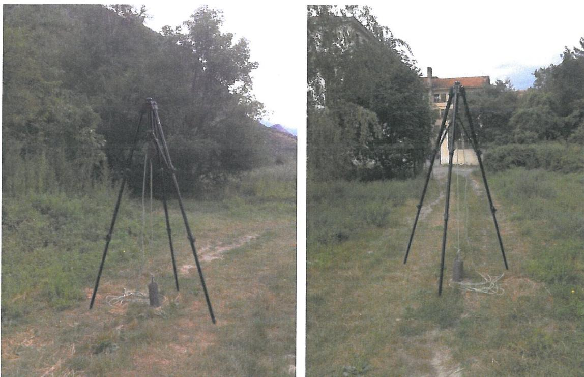
*Figura 1 – Massa battente posizionata a una trentina di metri dall'edificio della casa di riposo*
