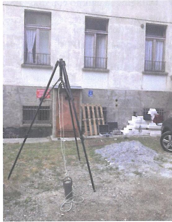
*Figura 2 – Massa battente posizionata a distanza di una trentina di metri e in prossimità dell'edificio della casa di riposo.*
