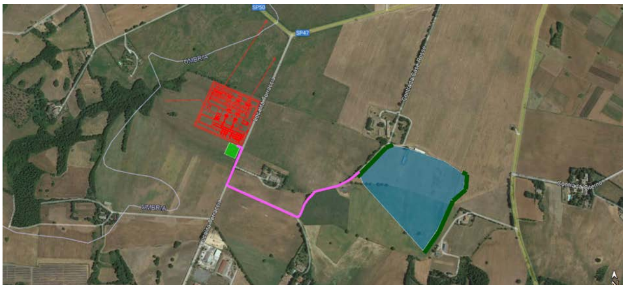
Figura 16 – Tracciato cavidotto MT verso nuova SE
