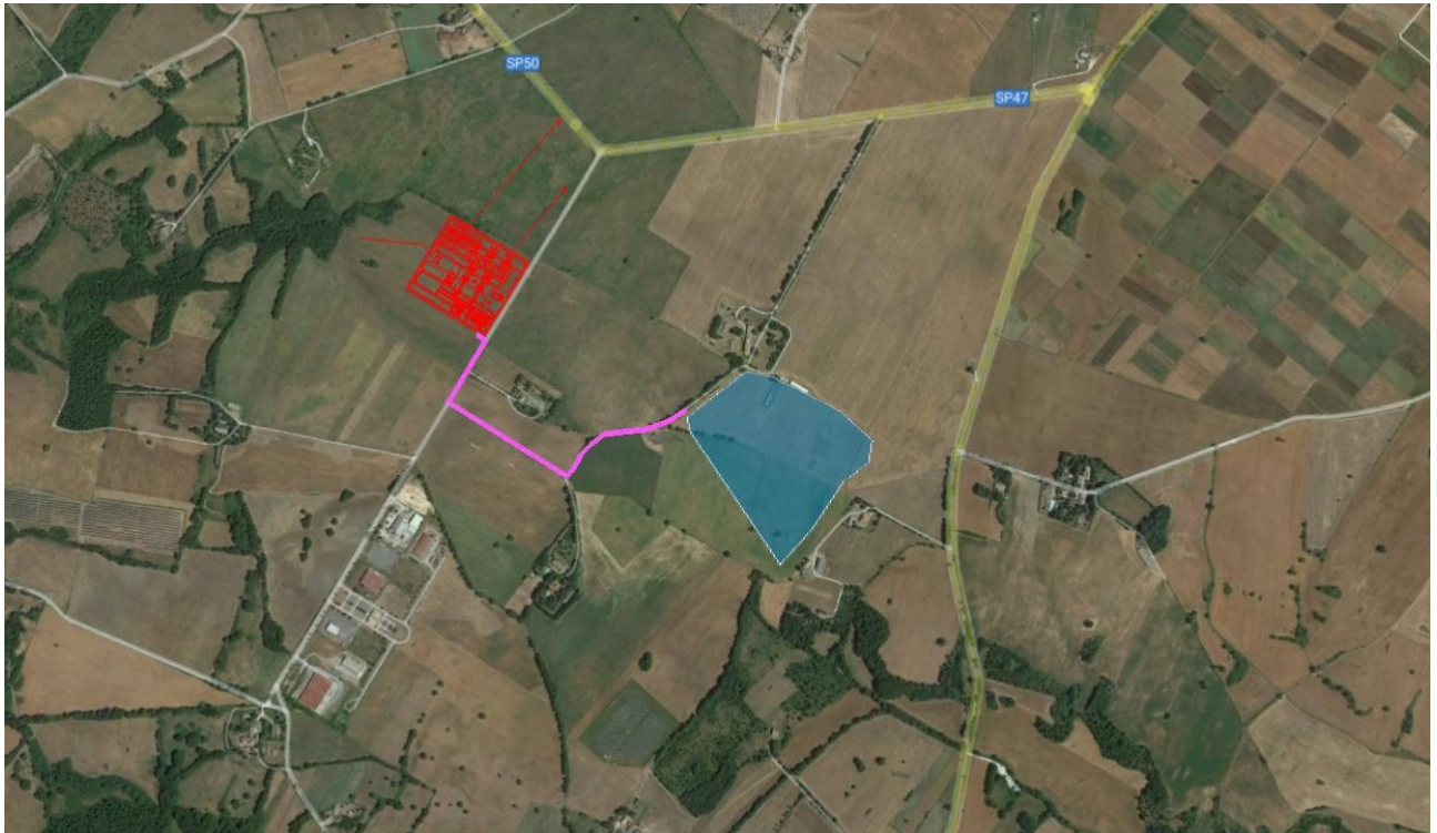
Fig. 7 – Tracciato cavidotto MT verso SE
