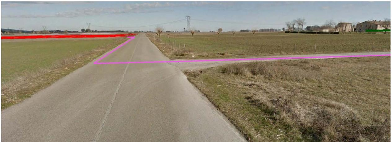
**Figura 3- Inserimento cavidotto MT da strada vicinale a strada località Torraccia**
