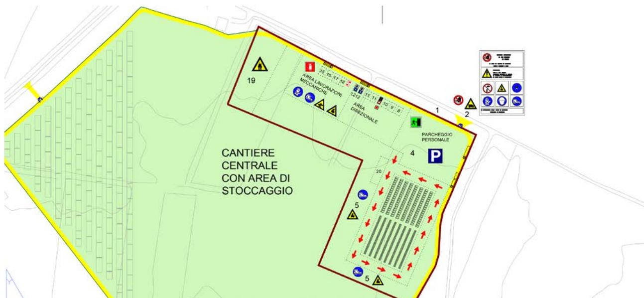
Fig.2 – Fase di ricezione, stoccaggio e movimentazione materiali, dettaglio apprestamenti
