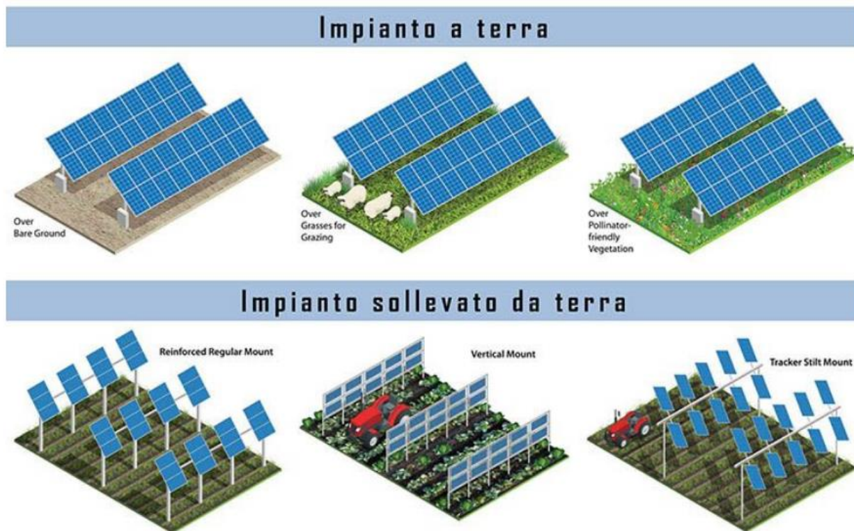
Figura 19 - Tipologie di impianti agrivoltaici, fonte NREL
