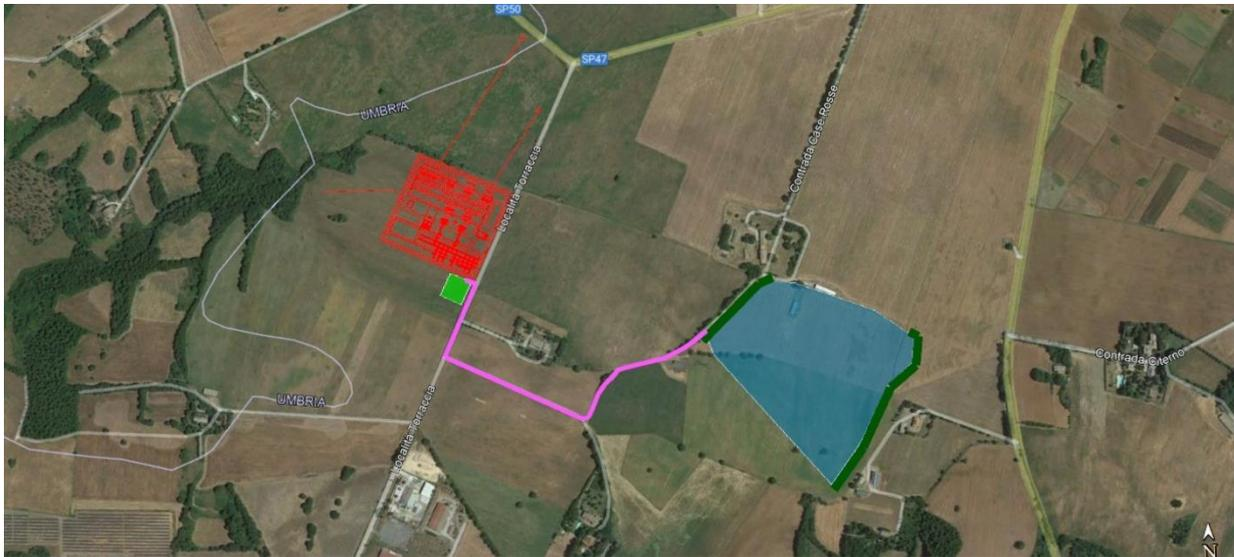
Figura 26- Tracciato del cavidotto MT esterno verso la nuova SE
