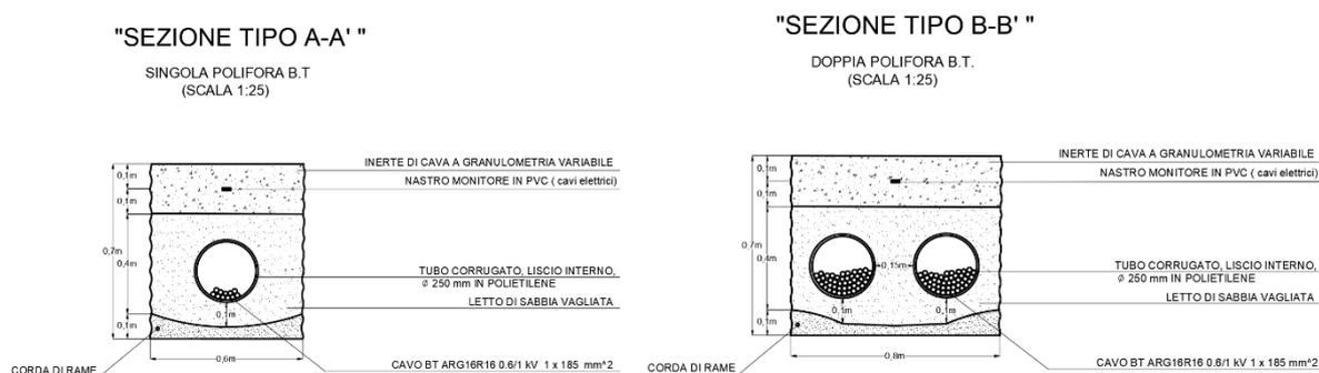
Figura 34- Cavidotti BT interni
