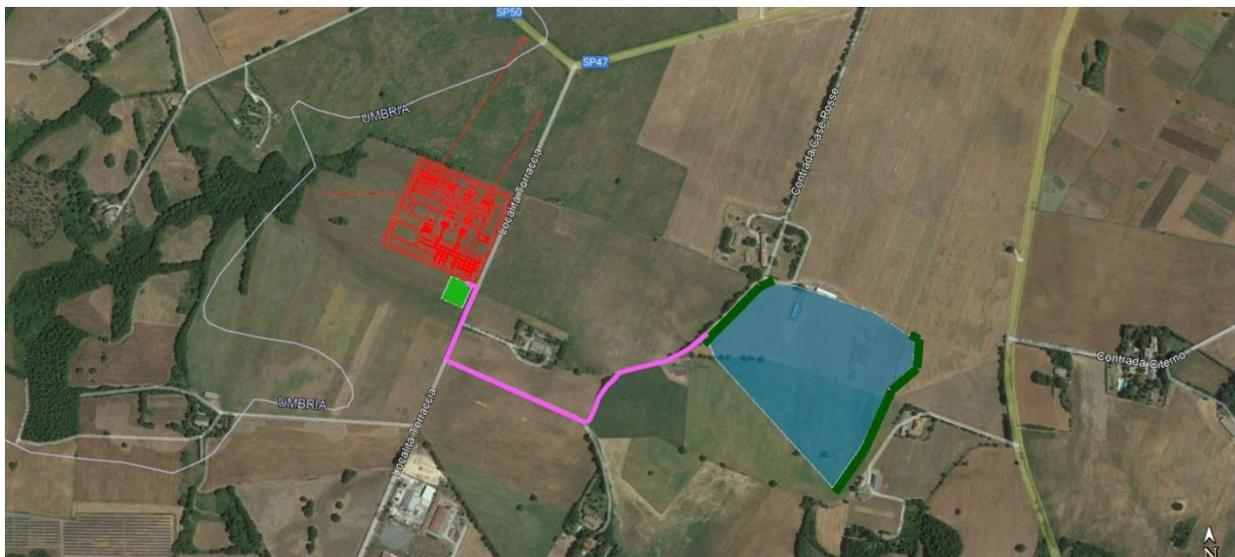
*Figura 30- Tracciato del cavidotto MT esterno verso la nuova SE*
