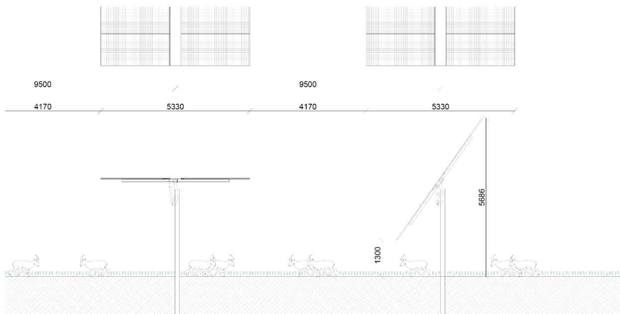
Figura 23 - Sezione tipo dell'assetto agrovoltaico
