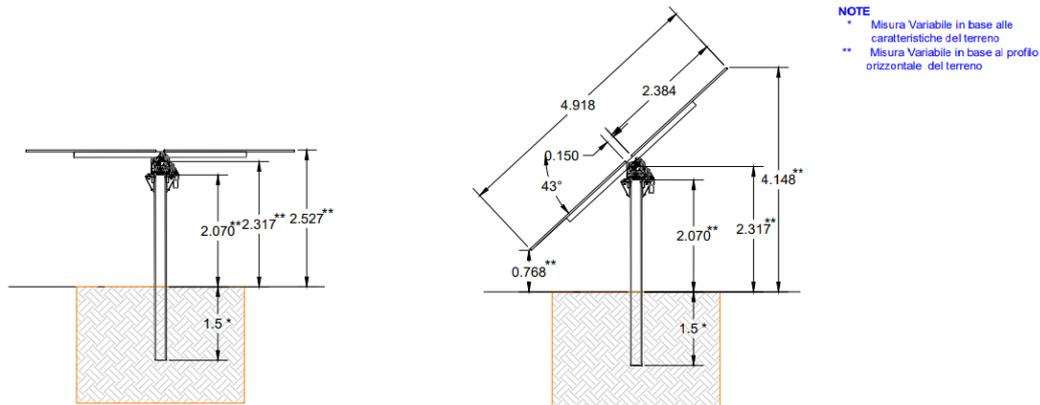
I pannelli saranno di tipo monocristallino disposti in direzione est-ovest, in modo da inseguire il sole durante l'intero percorso lungo la volta celeste e massimizzare la produzione di energia.
