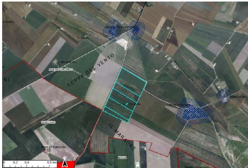
In riferimento al percorso di collegamento alla sottostazione 30/36kV, il cavidotto sarà interrato alla profondità di 1,20-1,50m. Lungo il suo tracciato affiancherà per 900m il tratturello Motta Villanova e attraverserà trasversalmente il tratturo regio Aquila – Foggia.
