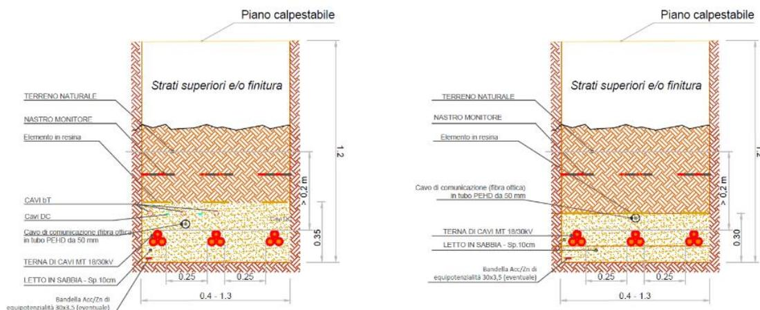
Fig. 30. Particolare: tipico scavo MT; a sinistra, con presenza di cavi bT.
