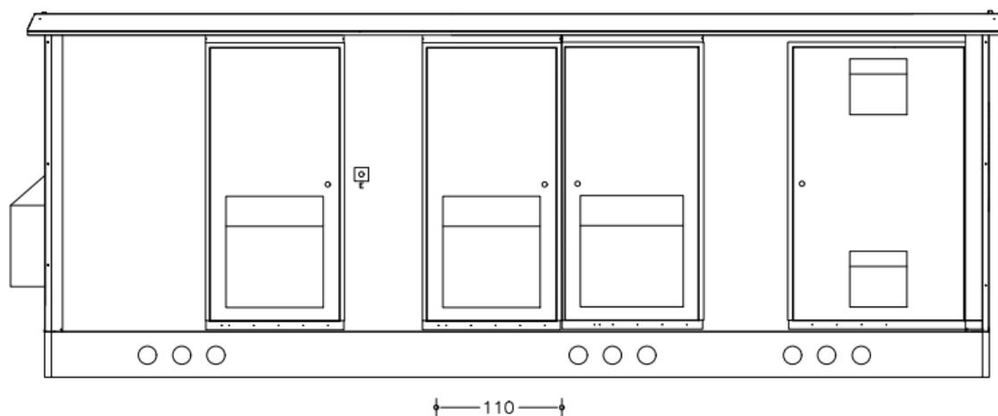
Fig. 24. Pianta, e prospetto e cabina MASTER e SLAVE (dimensioni principali 8,25 x 2,40 x 3,20h)
