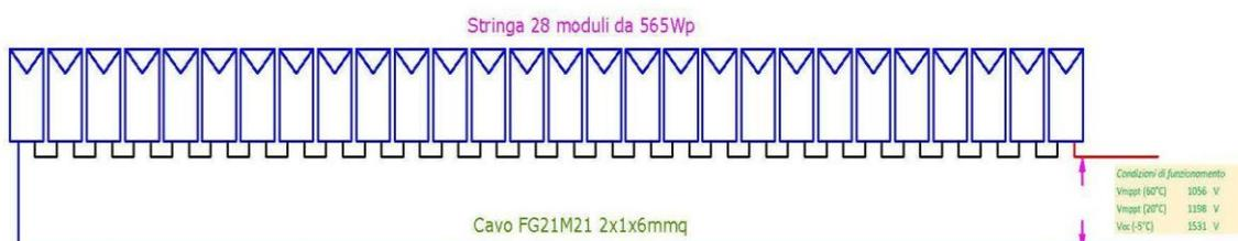
Fig. 18. Particolare serie moduli fotovoltaici.
