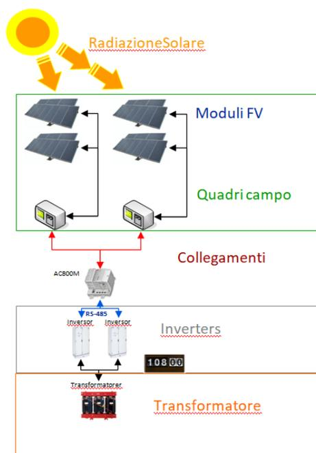
Fig. 5. Schema di principio del generatore fotovoltaico.
