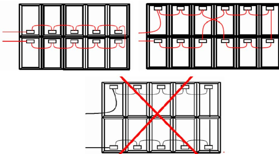
Fig. 38. Estratto dalla guida tecnica CEI 82-25 relativa alla modalità di cablaggio di stringa.
