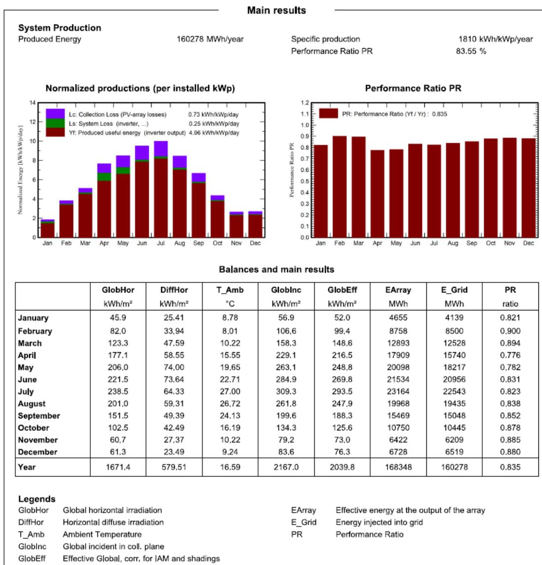
**Fig. 11. Principali risultati della Simulazione di Producibilità dell’Impianto (fonte PVsyst V7.2.5).**
