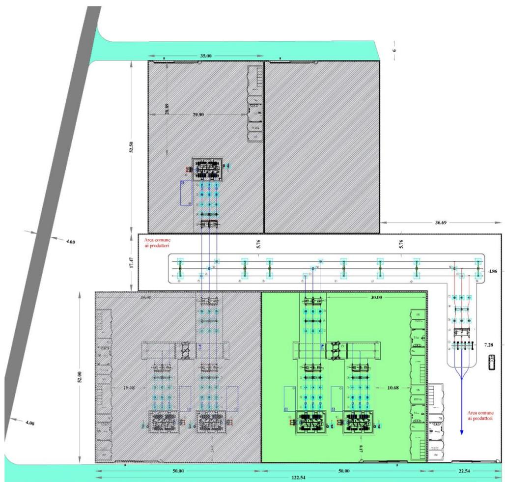
**Fig. 6.** Inquadramento delle opere di Rete: in verde, lo stallo del produttore AM ENERGY 2 della SSE; in blu, l’elettrodotto AT 150 kV.
