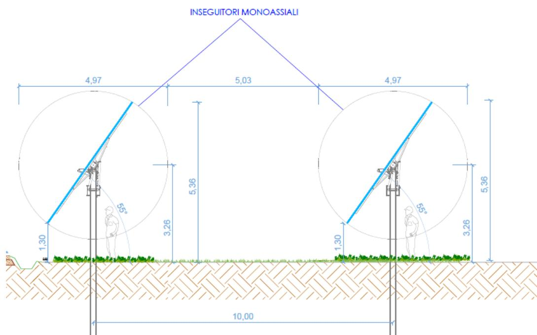
**Fig. 17.** Vista in sezione laterale del tracker-tipo, con altezze minime e massime raggiunte dai moduli nelle posizioni di estrema rotazione.
