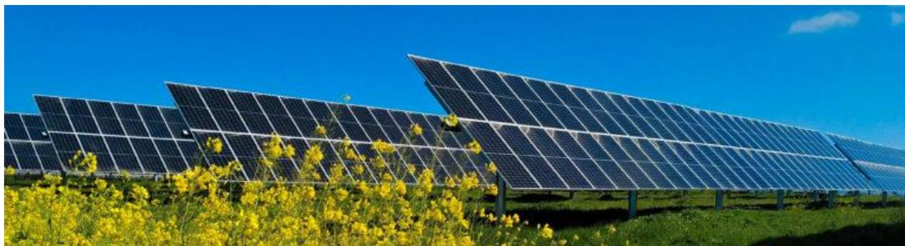
Fig. 15. Impianto ad inseguitori monoassiali di rollio, con pannelli bifacciali montati perpendicolarmente all'asse di rotazione.
