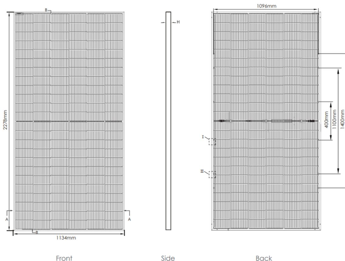
**Fig. 13. Dimensioni del pannello: estratto dal datasheet del pannello fotovoltaico di progetto.**
