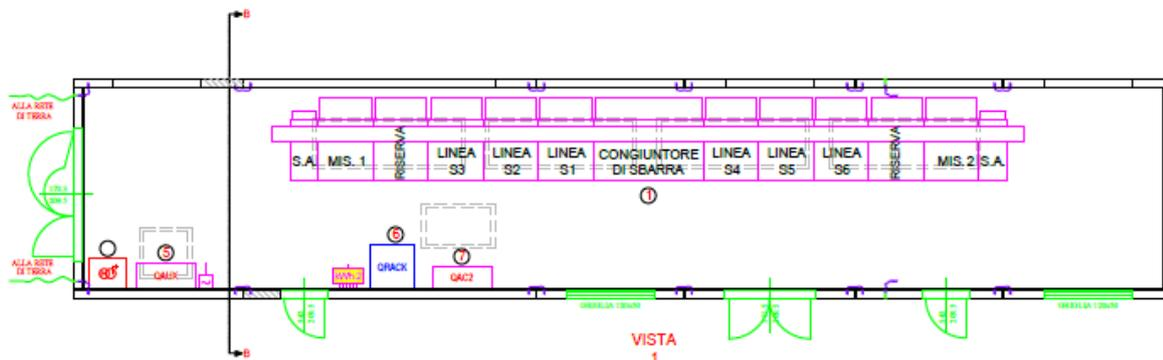
Fig. 25. Tipico PIANTA della Cabina di Raccolta: locale destinato a soli Quadri MT (dimensioni principali 15,00 x 3,00 x 4,50h).
