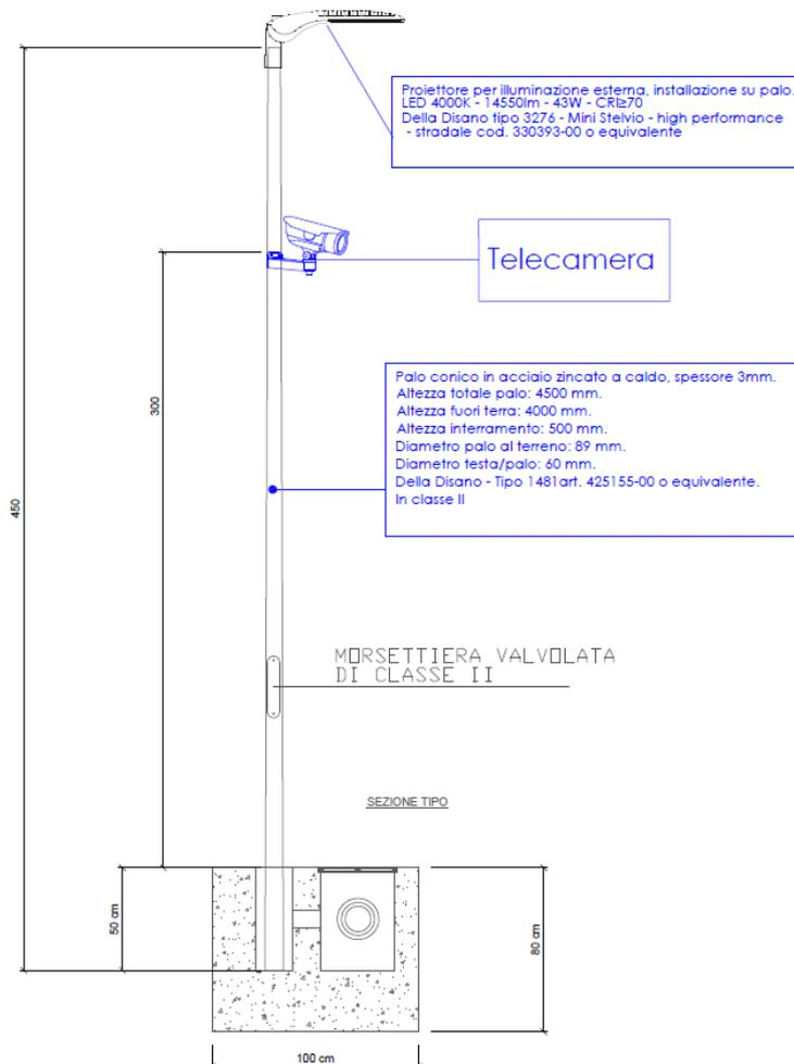
**Fig. 35. Installazione telecamera su palo preposto.**
