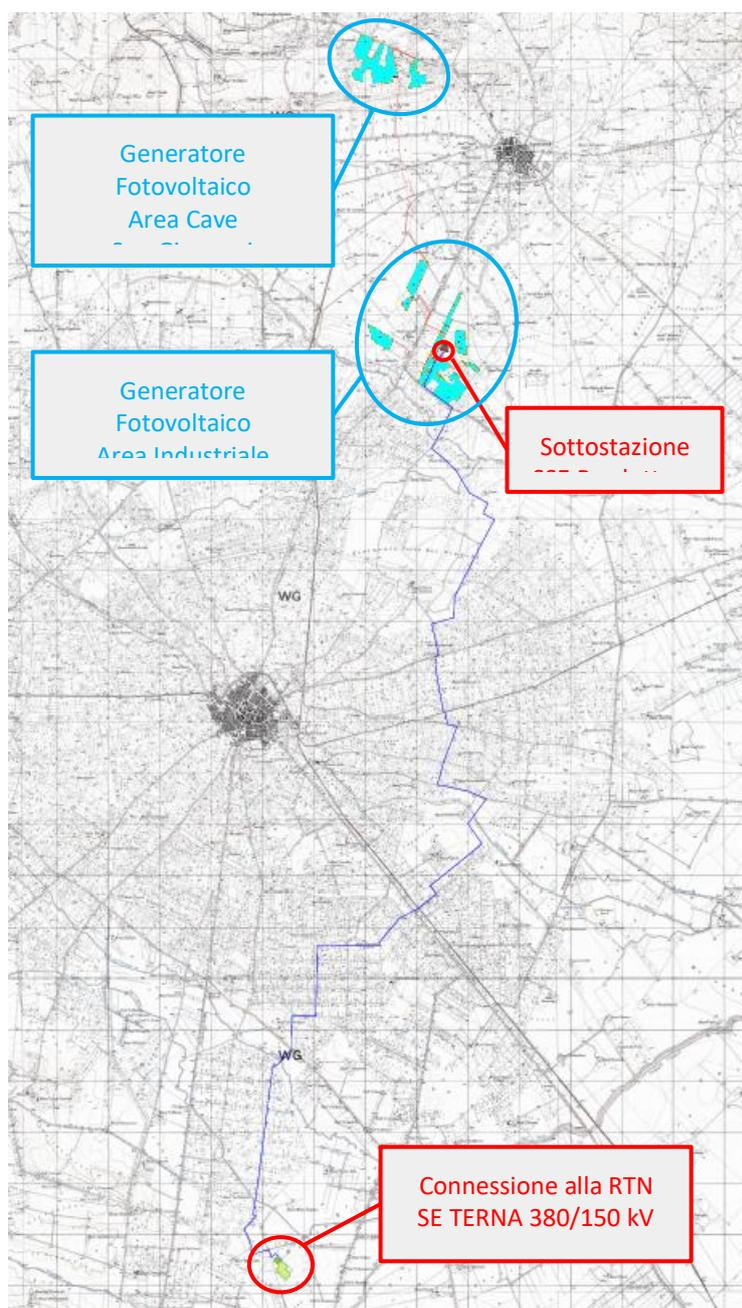
**Fig. 1.** Inquadramento di ampio raggio su IGM dell'area di intervento. A Nord, in celeste, la centrale agri-fotovoltaica; in blu il percorso dell'elettrodotto AT dorsale, che si sviluppa per circa 24,6 km prevalentemente lungo rete viaria esistente; in località San Sabino la Sottostazione SSE Produttore, a Sud la Stazione elettrica di Trasformazione SE-TERNA 380/150kV.
