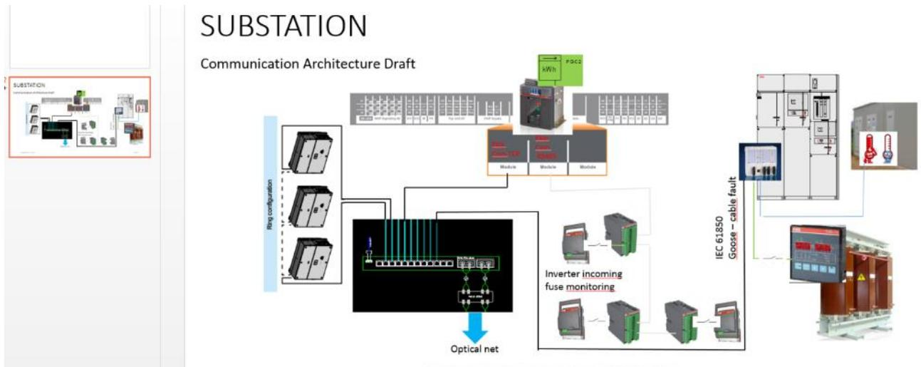
Fig. 36. Architettura del sistema di supervisione e controllo.
