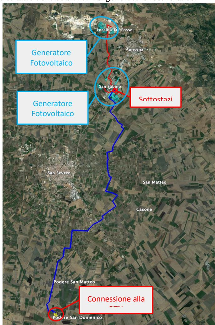
Fig. 7. Inquadramento di ampio raggio su ortofoto dell'area di intervento, a Nord, in celeste, la centrale fotovoltaica; in blu il percorso dell'elettrodotto AT dorsale, che si sviluppa per circa 24,6 km prevalentemente lungo rete viaria esistente; in loc. "San Sabino" ad Apricena (FG) la SSE Produttore e a Sud in Agro di San Severo (FG) la SE-TERNA 380/150 kV.
