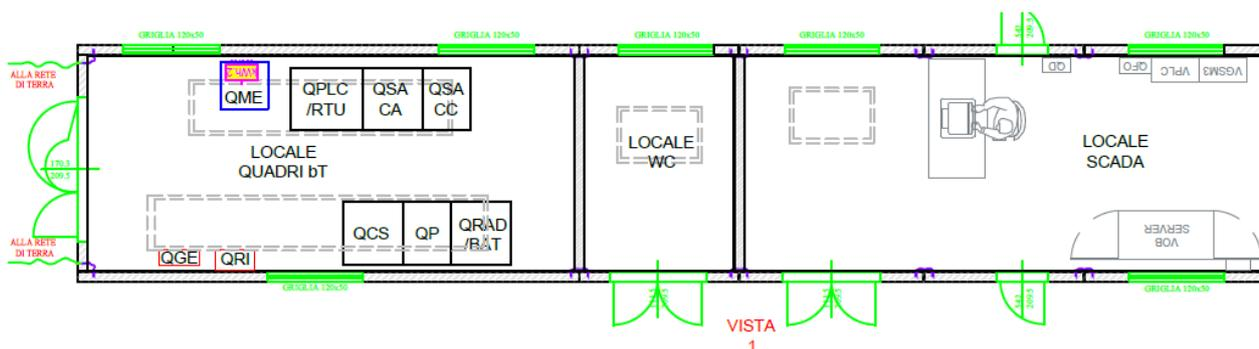
Fig. 26. Tipico PIANTA locali bT (dimensioni principali 15,00 x 3,00 x 4,50h).
