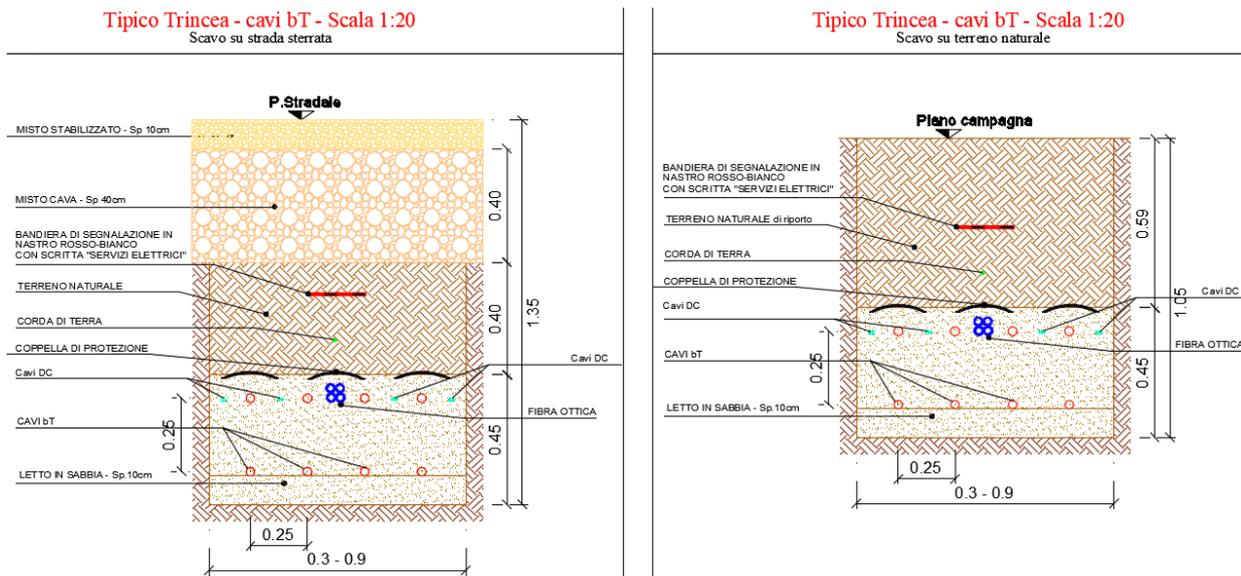
**Fig. 31. Particolare trincee per cavidotti BT, in formazione variabile, rispettivamente su strada sterrata e su terreno naturale.**
