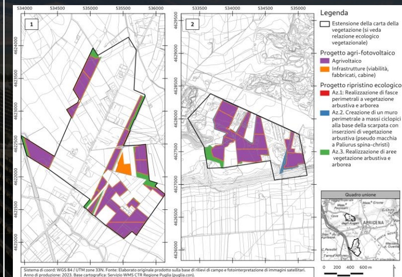
Figura 13 – Progetto di ripristino ecologico diviso per azioni
