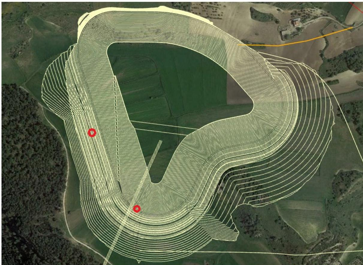
**Figura 11.1:** In rosso: ubicazione pozzi ad uso idropotabile, in giallo: opere progettuali sul bacino di monte
