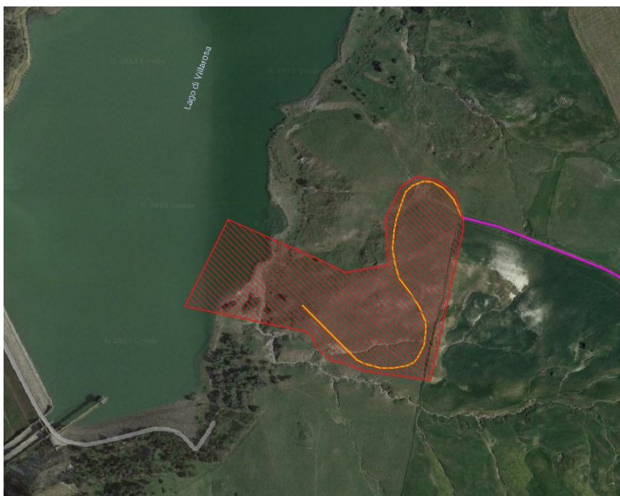
Figura 2.13: Area cantiere di valle (in arancio la Viabilità 7 da creare ed in magenta la Viabilità 6 da adeguare)
