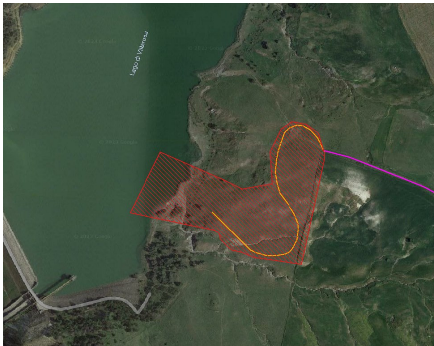
Figura 4.5: Area cantiere di valle (in arancio la Viabilità 7 da creare ed in magenta la Viabilità 6 da adeguare)
