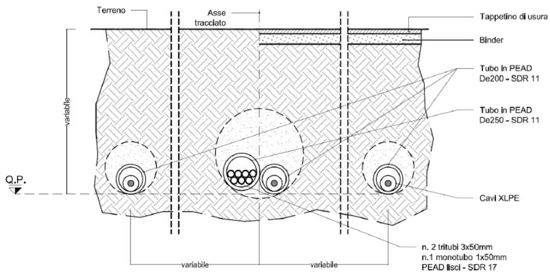
**NOTA:** le tubazioni rappresentate in figura sono utilizzabili per cavi con diametro esterno fino a 120 mm. Per cavi AT con diametro superiore si dovranno impiegare tubazioni PEAD con diametro esterno 225 mm (idonea a contenere cavi con diametro esterno fino a 135 mm) o 250 mm (idonea a contenere cavi con diametro esterno fino a 150 mm).
