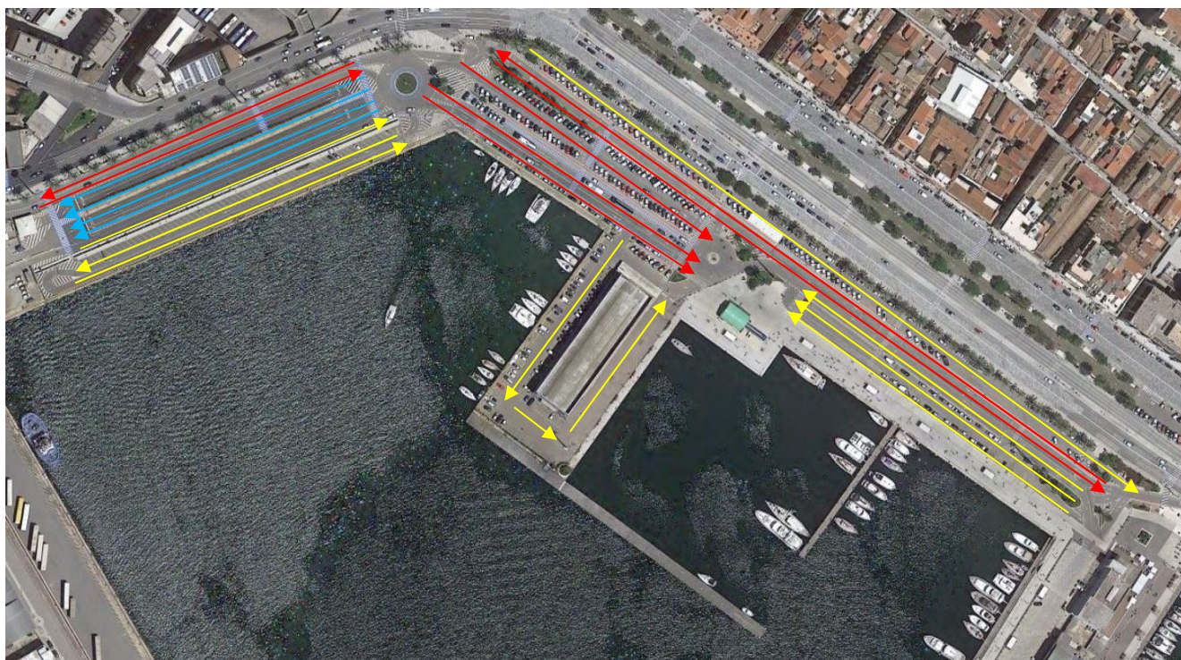
Planimetria della configurazione attuale dell'area del Porto Storico: in rosso la viabilità ordinaria, in giallo la viabilità di servizio/parcheggi, in celeste le corsie carrabili di imbarco
