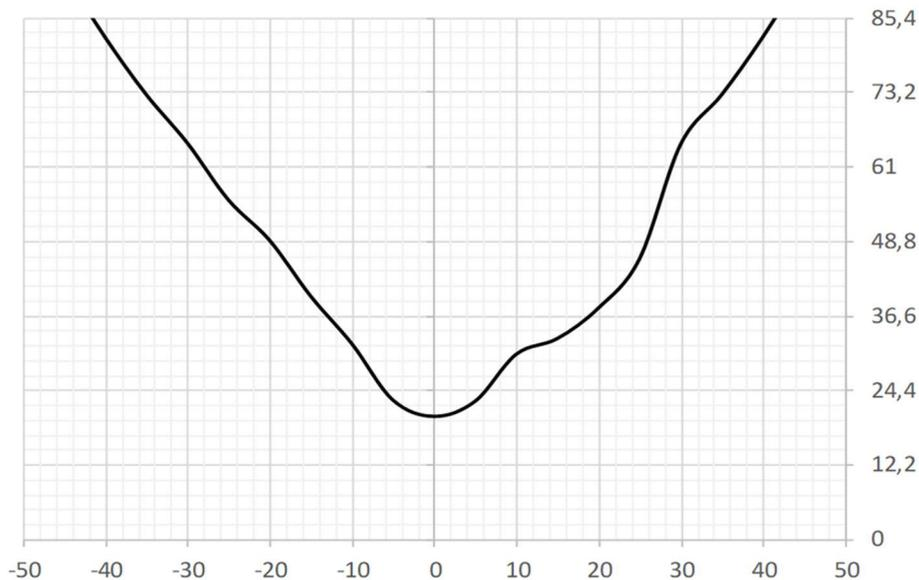
Come si può notare ad un angolo di circa  $+30^\circ$  o maggiore il valore di  $U_{cr}$  è di circa 60m/s quindi di molto superiore rispetto il posizionamento a  $0^\circ$  di tilt, il che rende la posizione di protezione a  $30^\circ$  preferenziale.
