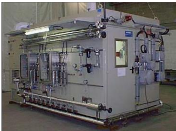
Figura 39 - Skid Sistema di analisi – Cabina cromatografi
