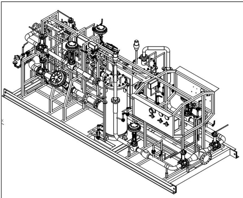
**Figura 27** - "Skid" tipologico con doppia pompa per GNL
