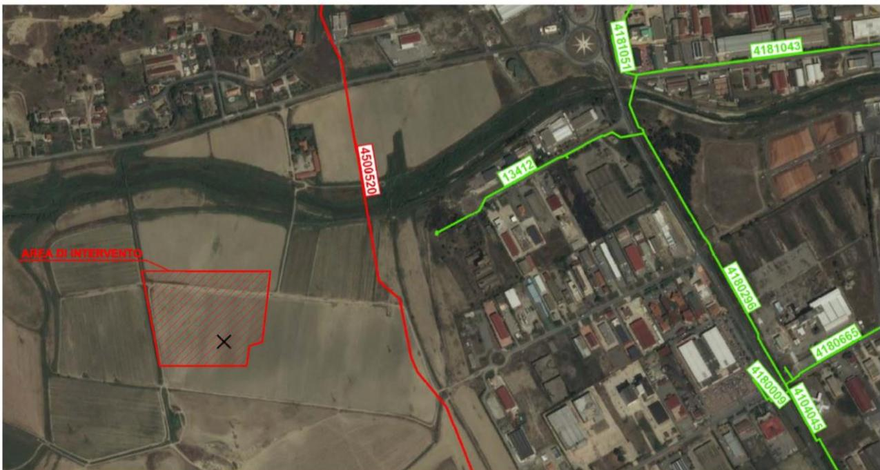
**Figura 21** – Ortofoto con individuazione della rete gas di SNAM
