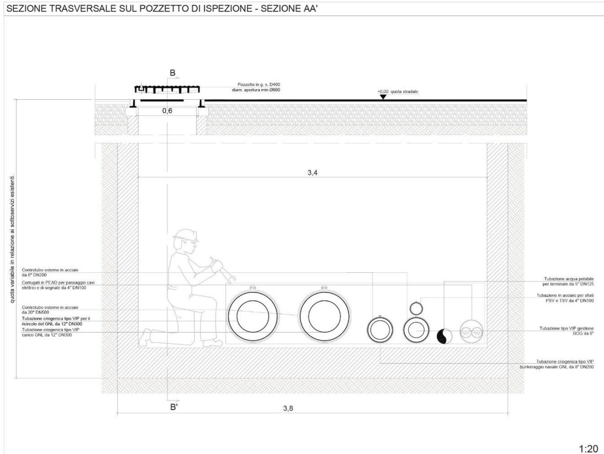
**Figura 18** – Sezione trasversale sul pozzetto di ispezione
