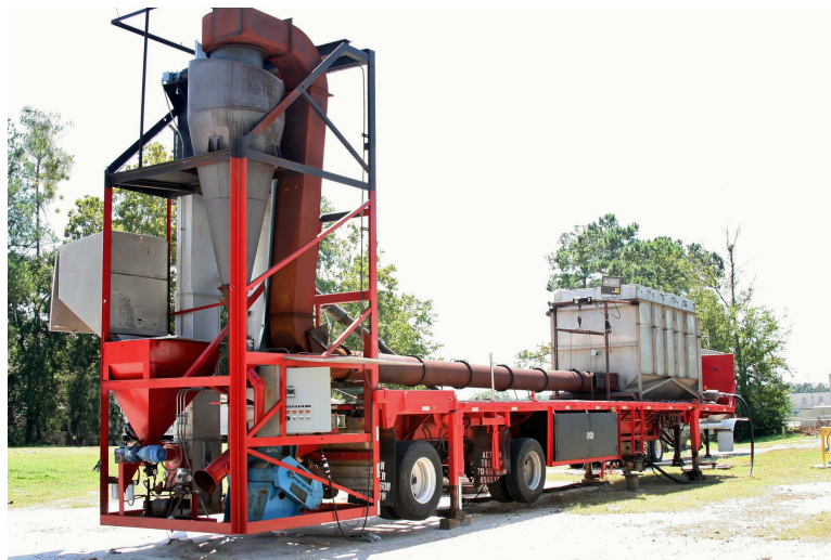
Figura 5. Unità mobile per l'espansione in-situ della perlite
