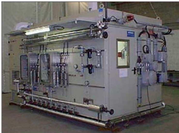
Figura 30 - Skid Sistema di analisi – Cabina cromatografi
