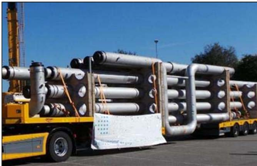
Figura 16 - Loops di espansione per le tubazioni VIP
