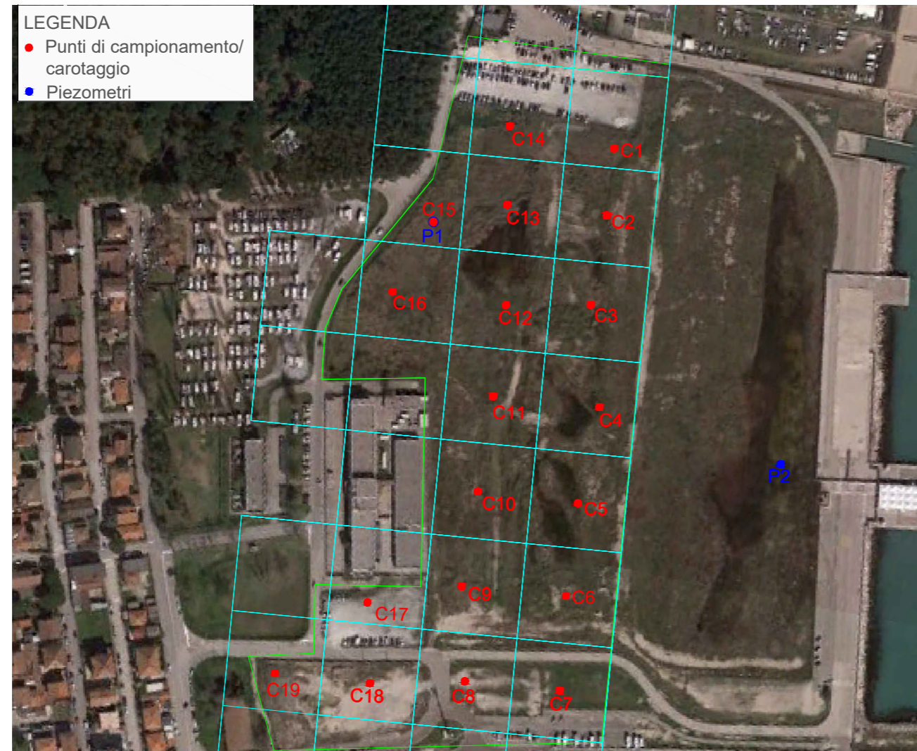
Griglia quadrata di campionamento per l'operazione di carotaggio
