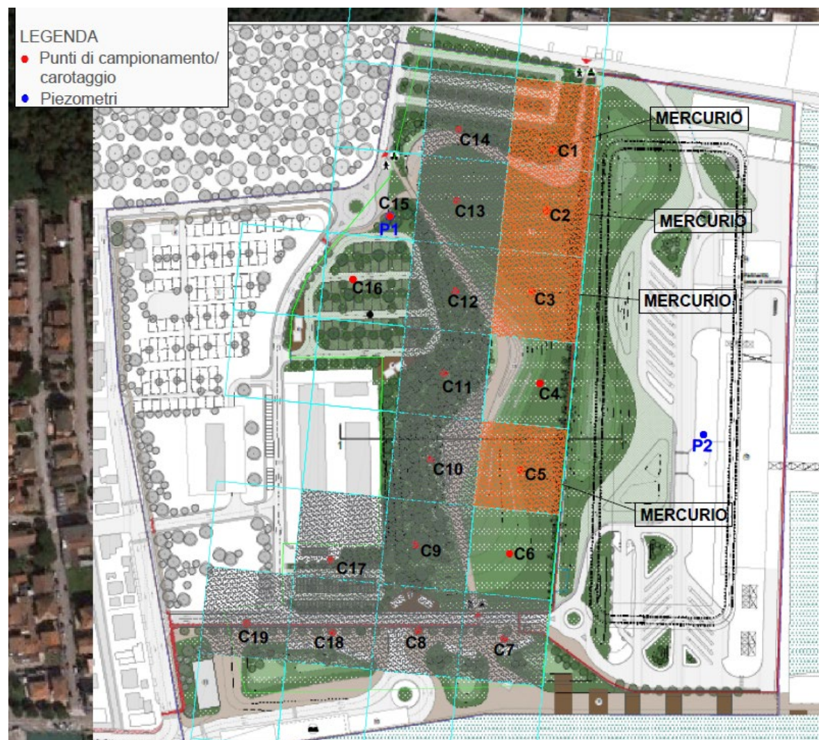
Figura 12 - risultati caratterizzazione – sintesi 2-3 m (in grigio sono indicate le celle non oggetto di caratterizzazione alla profondità di 2-3 m dl p.c.; in arancione è indicato il superamento delle CSC di colonna A; sono indicate le sostanze per cui si ha il superamento delle CSC)
