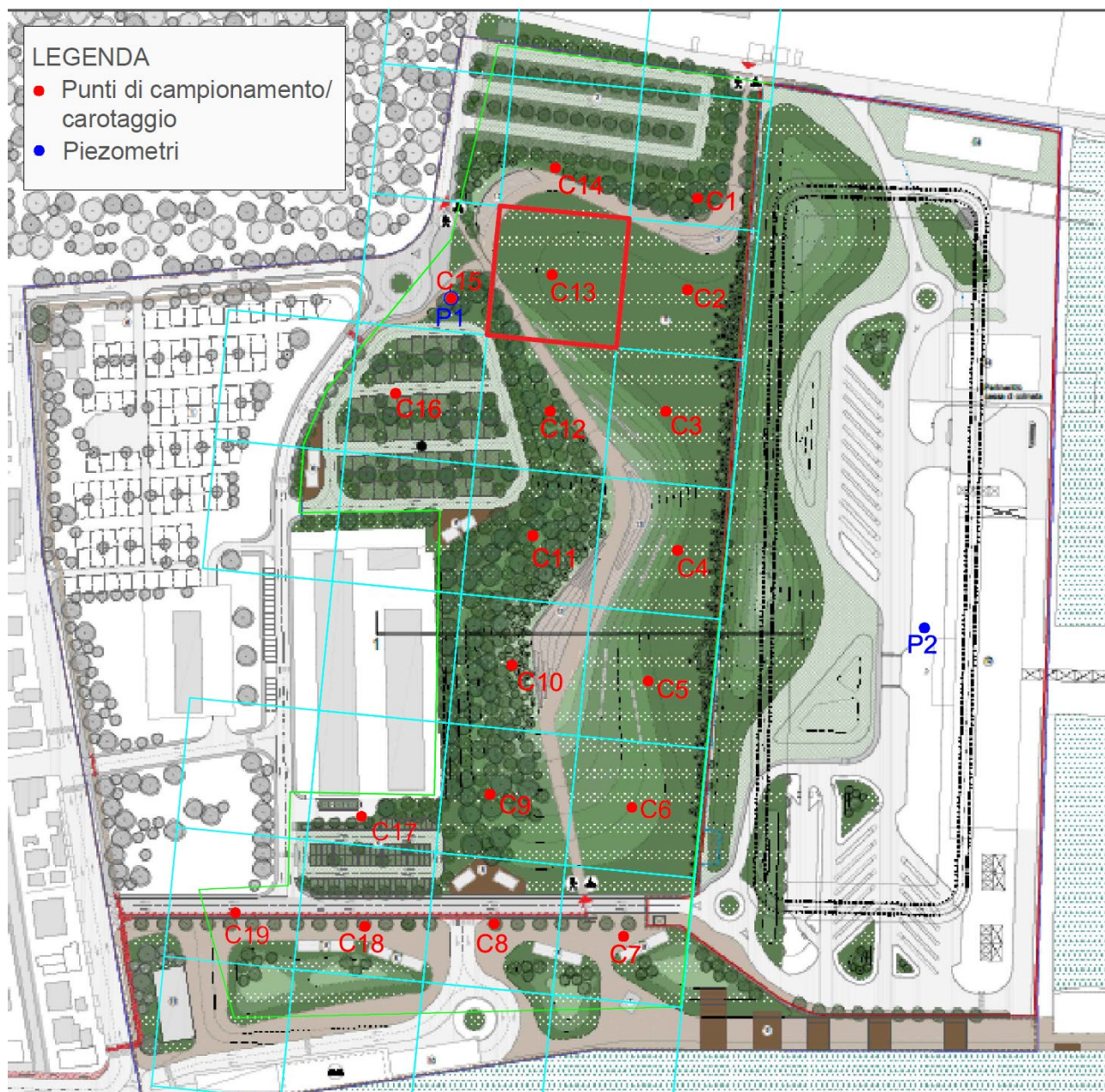
Figura 17 – indicazione della cella C13 oggetto dell'attività di bonifica
