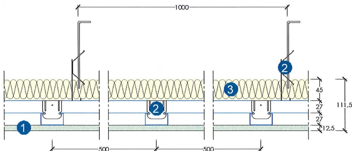
Controsoffitto Gyproc CS.P. 27/48 L Hydro dello spessore totale di 111,5 mm circa costituita dagli elementi sottoelencati:
