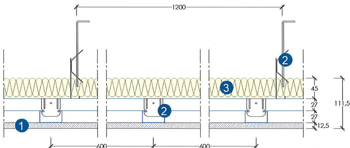
Controsoffitto Gyproc CS.P 27/48 L STD dello spessore totale di 111,5 mm circa costituita dagli elementi sottoelencati:
