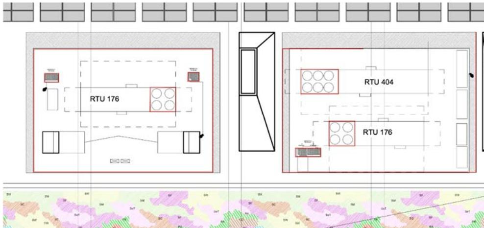
**Figura 26 – Planimetria con indicazione delle barriere acustiche presenti in prossimità degli impianti – lato NORD**
