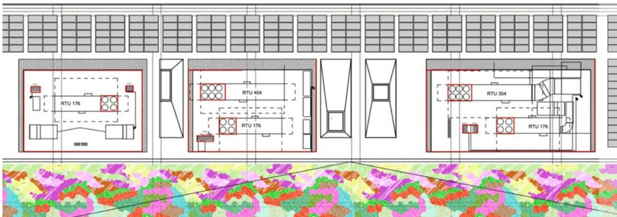
Figura 14 - Edificio Terminal, Copertura: Impianto aeraulico climatizzazione
