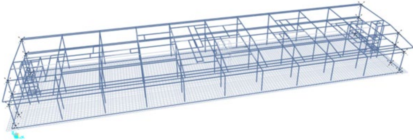
Figura 15.1: Punti di controllo sul modello FEM per la valutazione del drift interpiano
